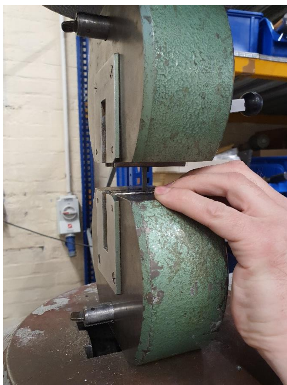
Slika 22. Pozicioniranje ispitnog uzorka u čeljusti WPM EU 40 MOD kidalice
