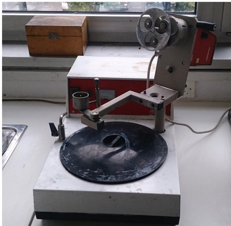
Slika 28. Struers Pedemin stroj za brušenje
