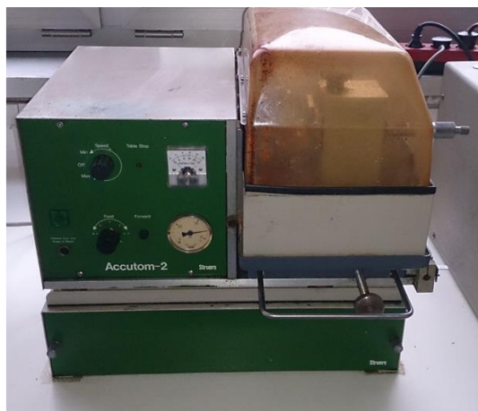
Slika 25. Struers Accutom-2 s vodenim hlađenjem rezalica
