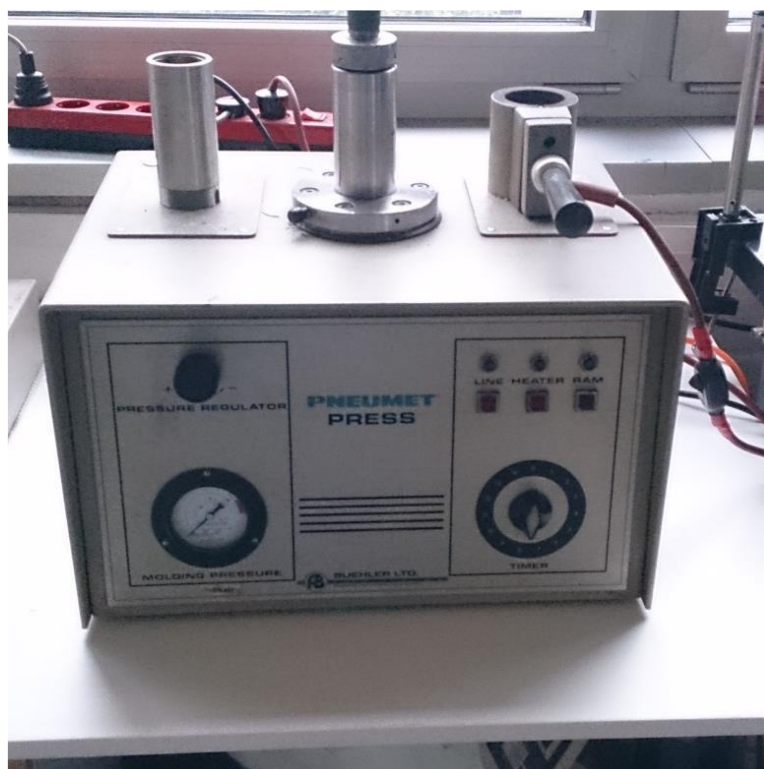
Slika 26. Buehler Ltd. Pneumet Press stroj za ulijevanje uzoraka u polimernu smjesu
