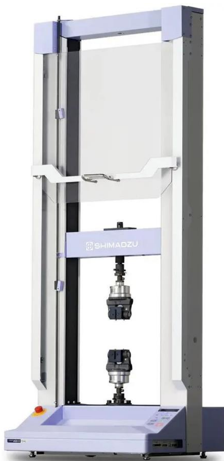
Slika 19. Shimadzu AGS – X kidalica [27]
