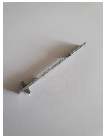
Slika 23. Prikaz pokušaja improviziranog eliminiranja klizanja epruветa iz čeljusti
