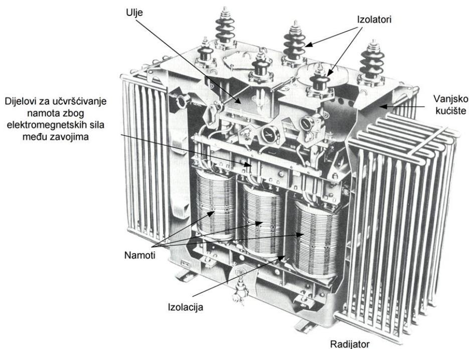
**Slika 7:** Dijelovi transformatora [29].
