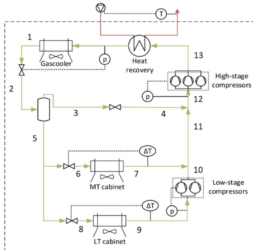
**Slika 10:** Shematski prikaz transkritisnog rashladnog CO<sub>2</sub> booster sustava. Adaptirano prema [34]
