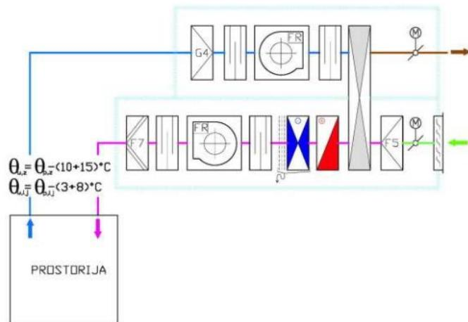
Slika 5: Klimatizacijsko postrojenje s grijanjem i hlađenjem zraka [28]
