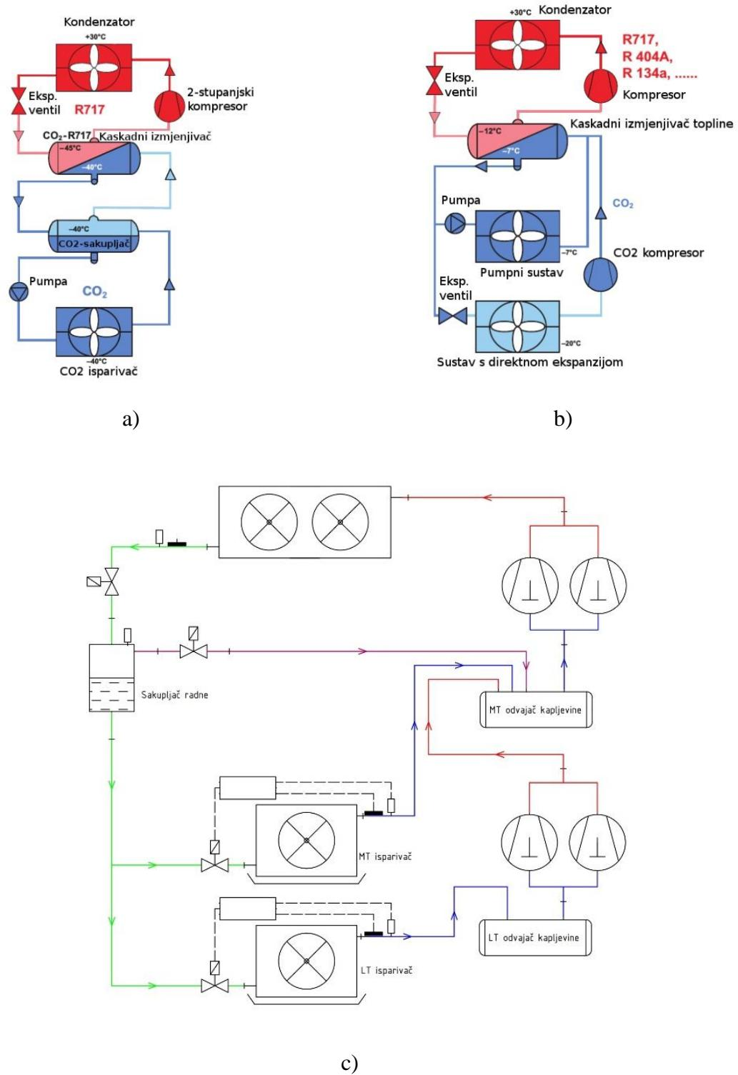
**Slika 3:** Sheme sustava s radnom tvari R744: a) kao prijenosnik energije b) kaskadni rashladni sustav s direktnom ekspanzijom  $\text{CO}_2$  c) transkritični rashladni  $\text{CO}_2$  booster [25]
