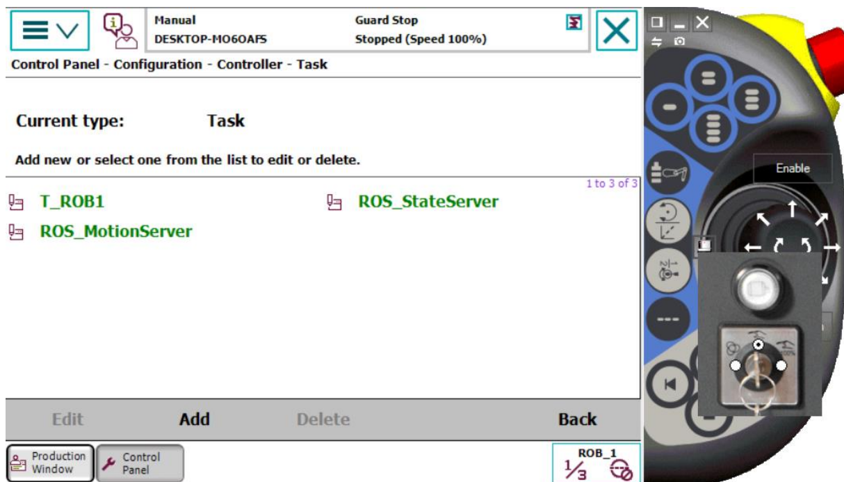
Slika 37 Procesi instalirani na virtualni kontroler
