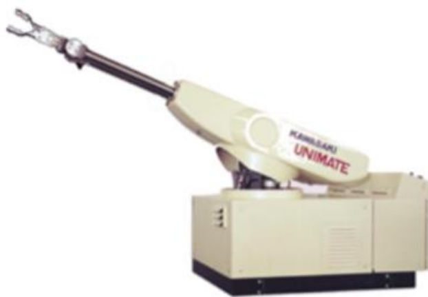
Slika 1 Robot Unimate - prvi industrijski robot [2]
