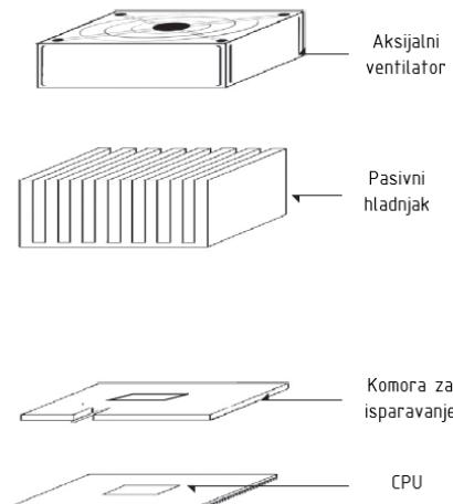
**Slika 42.** Shema sustava za hlađenje CPU-a [34]
