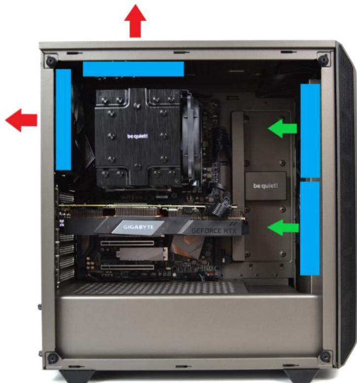
**Slika 51. Protok zraka kroz kućište osobnog računala [43]**
