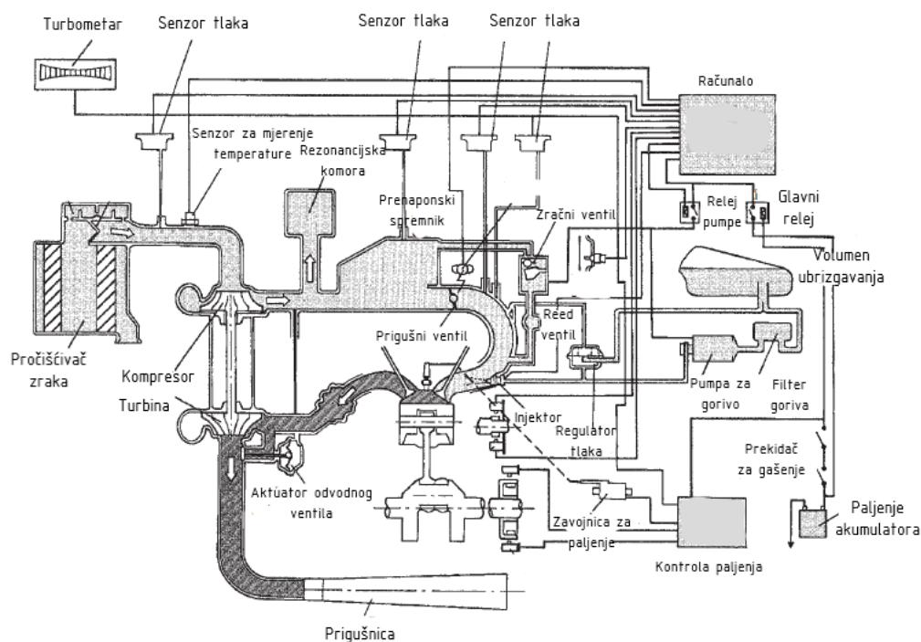
**Slika 9. Računalom upravljan sustav za dovod goriva kod automobila [5]**
