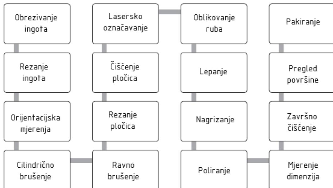
Slika 31. Shema izrade pločica silicija [25]
