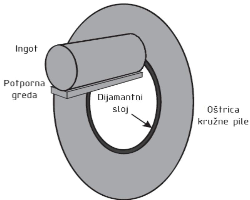
*Slika 32. Kružno piljenje ingota [25]*
