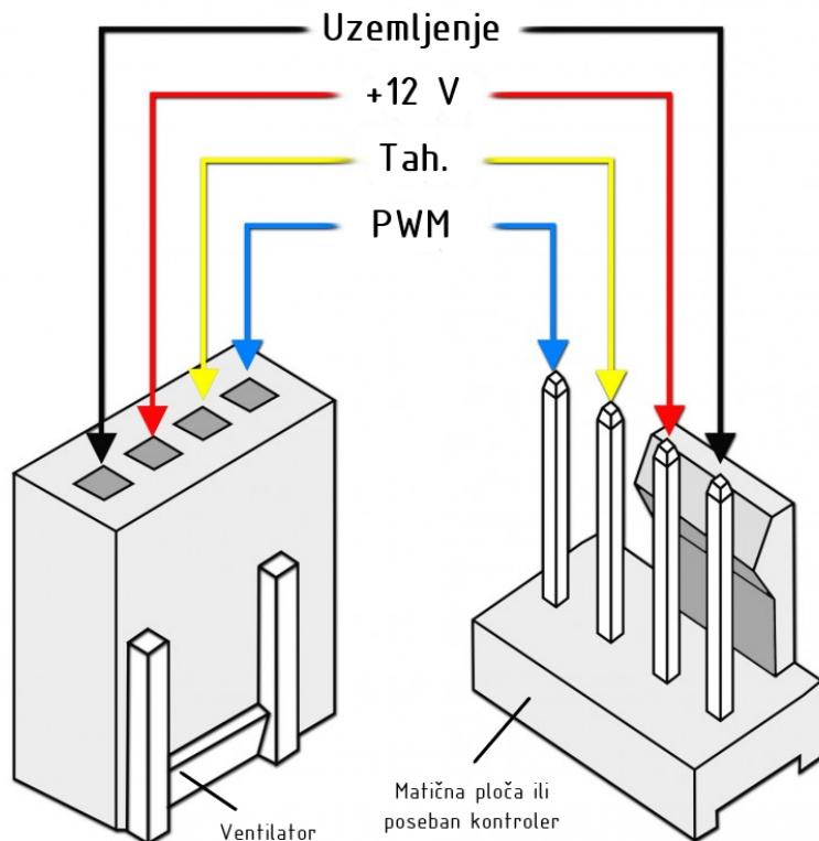
**Slika 57.** Shema priključka ventilatora s 4 žice [48]
