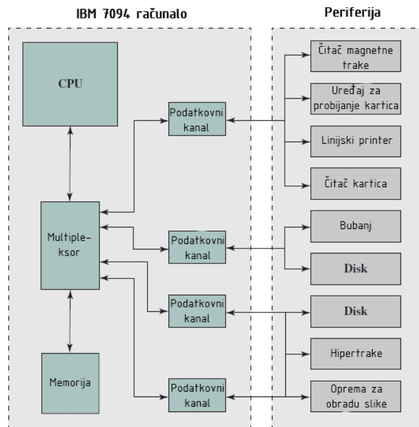
Slika 5. Struktura računala IBM 7094 [4]
