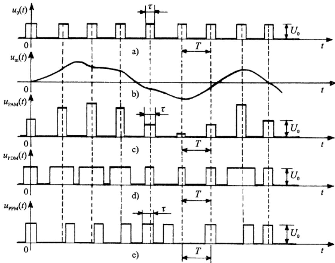
Slika 53. Impulsna modulacija. a) valni oblik prijenosnoga signala; b) modulacijski signal; c) PAM-signal; d) PWM-signal; e) PPM-signal [44]
