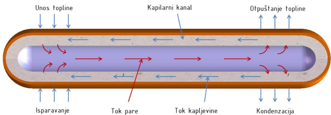
**Slika 44.** Princip rada toplinske cijevi zračnog hladnjaka [35]
