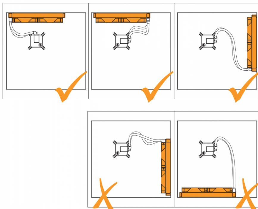
**Slika 47.** Položaj radijatora AIO-hladnjaka u kućištu računala [39]
