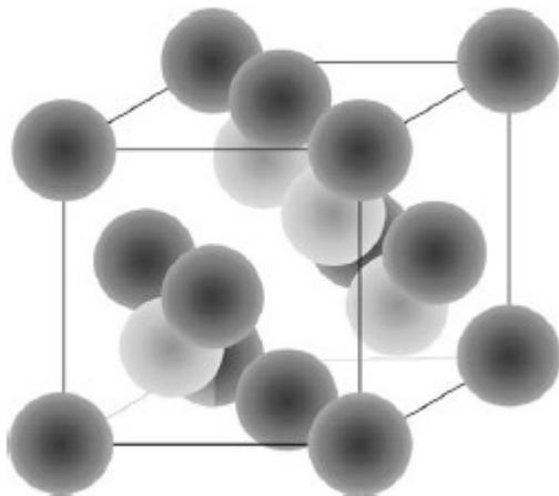
**Slika 27.** Položaj atoma silicija unutar jedinične celije silicija [22]
