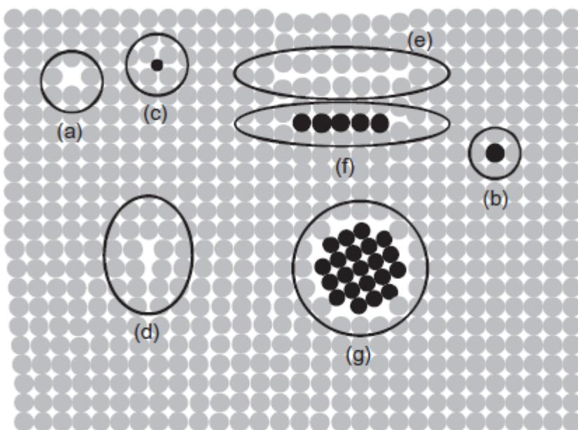
**Slika 29. Mogući defekti kristalne rešetke silicija [22]**
