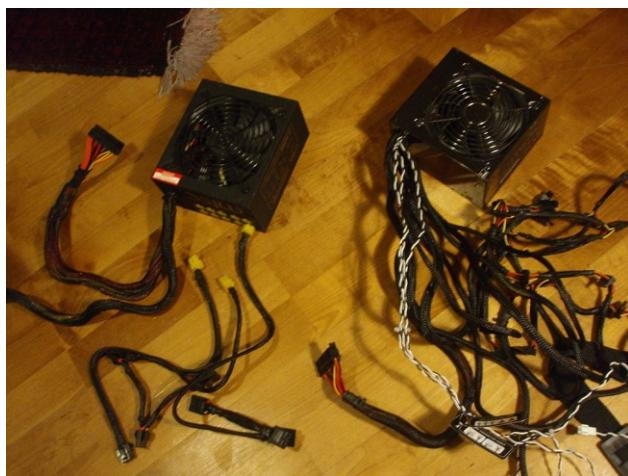
**Slika 22. Modularno napajanje (lijevo) i napajanje s integriranim kablovima (desno) [16]**
