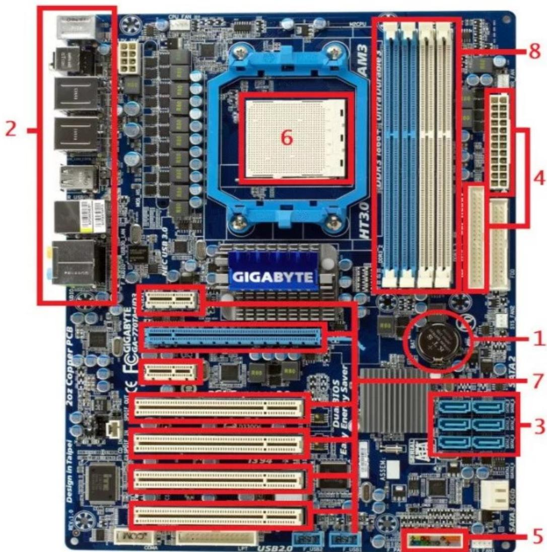
Slika 14. Struktura matične ploče proizvođača Gigabyte [11]
