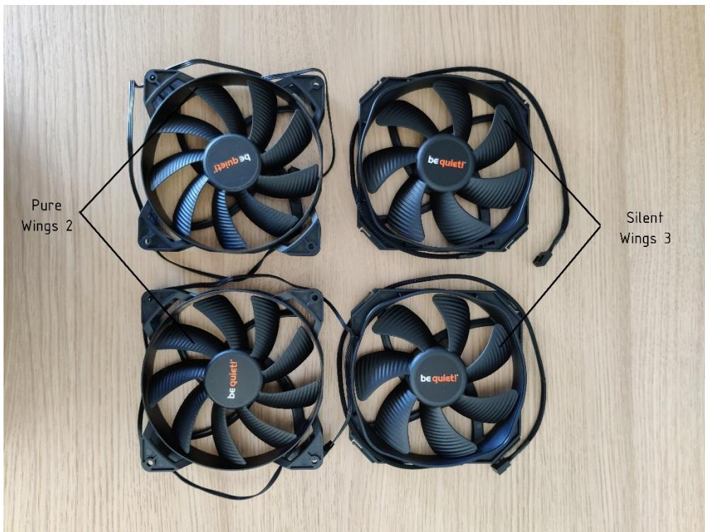
**Slika 67.** Pure Wings 2 (lijevo) i Silent Wings 3 (desno) ventilatori proizvođača Be quiet!
