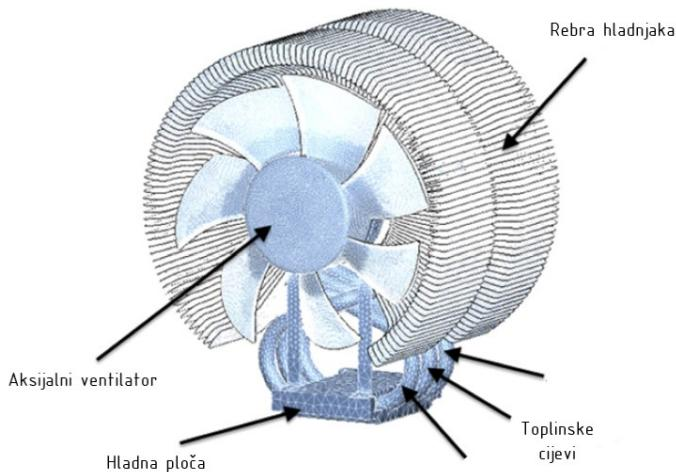
**Slika 45.** Alternativni zračni hladnjak [37]
