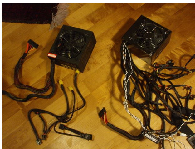
Slika 22. Modularno napajanje (lijevo) i napajanje s integriranim kablovima (desno) [16]
