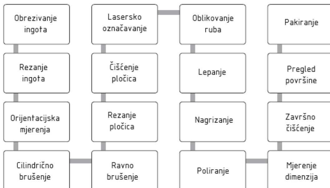
Slika 31. Shema izrade pločica silicija [25]
