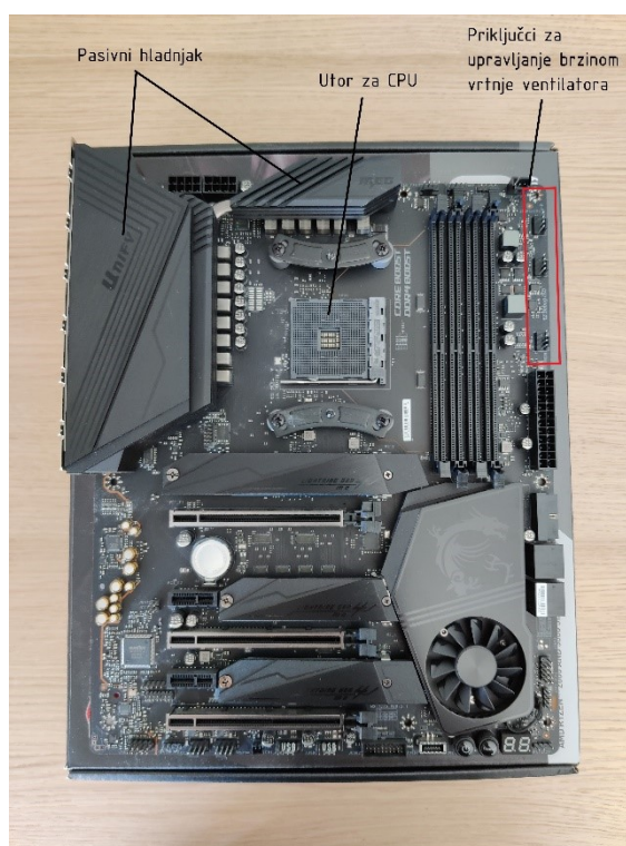
Slika 62. MSI MEG X570 UNIFY matična ploča
