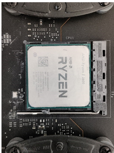
Slika 61. AMD Ryzen 5 3600 mikroprocesor
