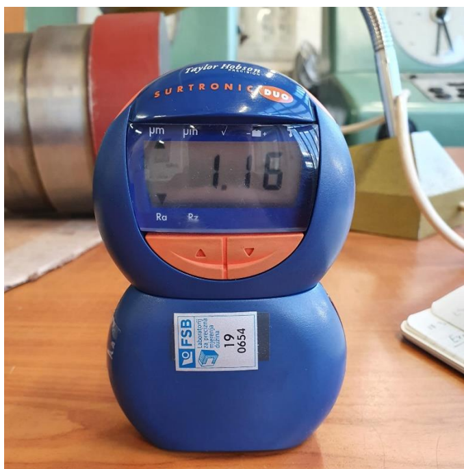
Slika 22. Prijenosni mjerač hrapavosti Taylor Hobson Surtronic DUO
