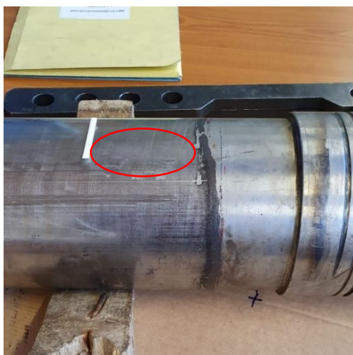
Slika 33. Mjerenje tvrdoće HV10, segment A, referentna površina
