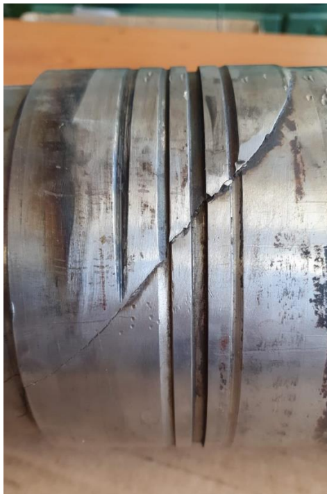
Slika 18. Urezi po opsegu vratila
