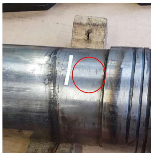
Slika 34. Mjerenje tvrdoće HV10, segment A, blago oštećena površina
