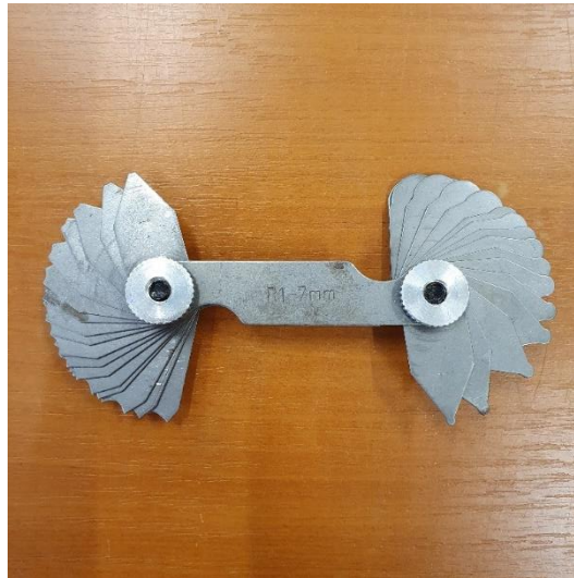
Slika 20. Mjerni listići za određivanje radijusa
