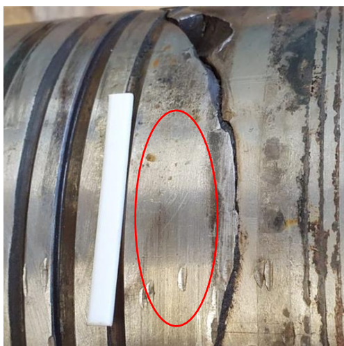
Slika 35. Mjerenje tvrdoće HV10, segment B, blizina pukotine
