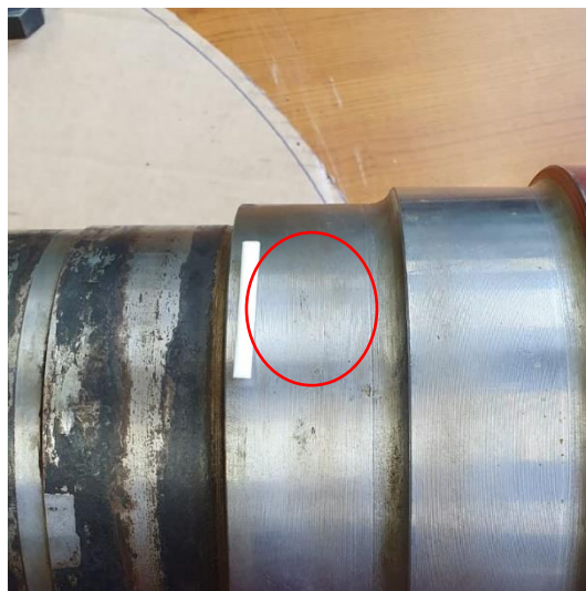
Slika 37. Mjerenje tvrdoće HV10, segment D
