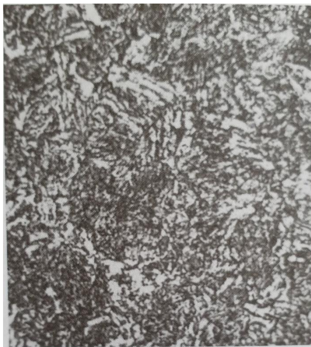
Slika 76. Primjer mikrostrukture iz literature -42CrMo4 čelična šipka, austenitizirano na 845°C, kaljeno u ulju na 65°C i žareno dva sata pri na 620°C. Struktura je mješavina martenzita, ferita i karbida. Uzorak je nagrižen 2% - tnom otopinom nitala, povećanje 750x[11]
