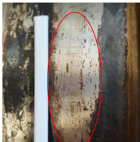
Slika 36. Mjerenje tvrdoće HV10, segment C
