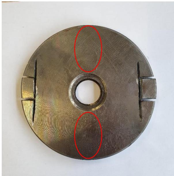
**Slika 70. Mjesta mjerena tvrdoće po cijeloj duljini presjeka**
