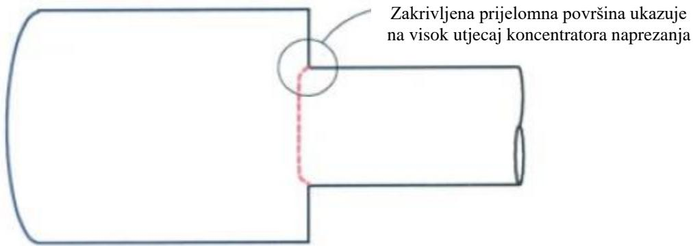
**Slika 11. Utjecaj koncentratora naprezanja na oblik prijelomne površine [3]**
