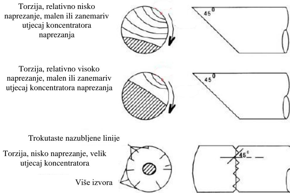
**Slika 12. Prijelomne površine pri torzijskom naprezanju [3]**
