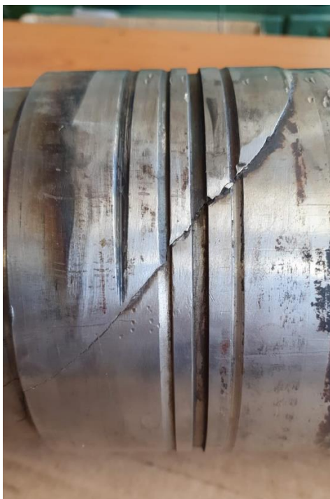
Slika 18. Urezi po opsegu vratila
