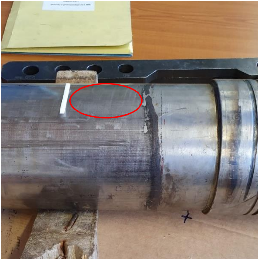
Slika 23. Segment A, referentna površina, pukotina s gornje strane
