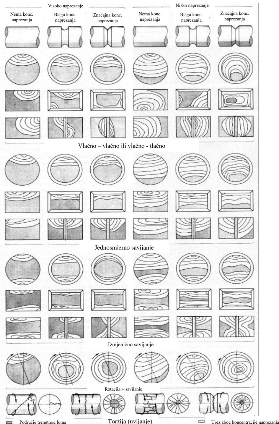
Slika 7. Izgled prijelomne površine ovisno o vrsti naprezanja [2]
