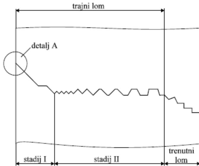
**Slika 2. Shematski prikaz propagacije pukotine do loma [1]**
