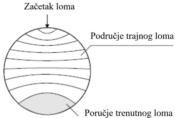
**Slika 1. Shematski prikaz prijelomne površine uzrokowane umorom materijala [1]**
