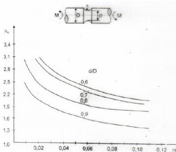
**Slika 21. Određivanje koeficijenta koncentracije naprezanja [6]**
