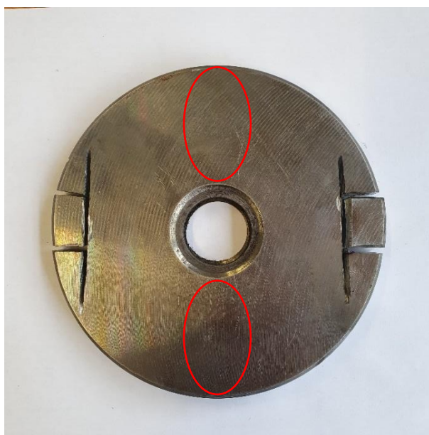
Slika 70. Mjesta mjerenja tvrdoće po cijeloj duljini presjeka
