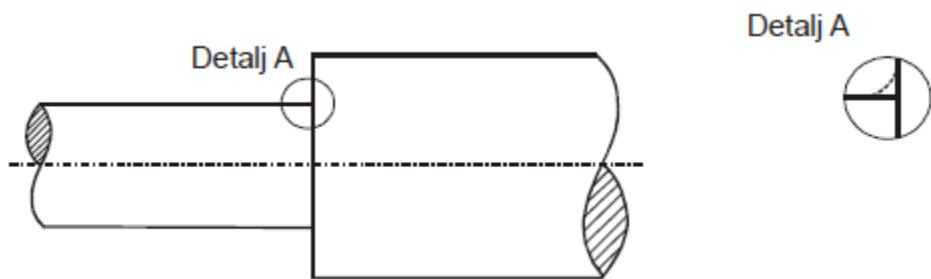
**Slika 3. Konstrukcijski koncentrator naprezanja [1]**
