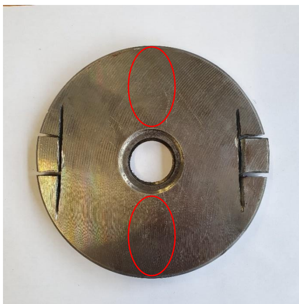
Slika 70. Mjesta mjerenja tvrdoće po cijeloj duljini presjeka
