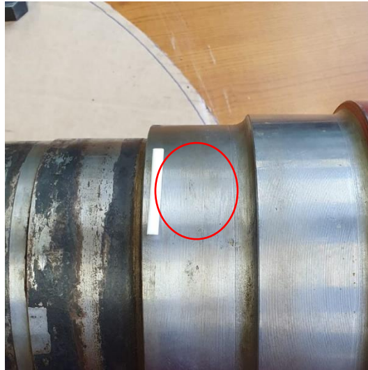
Slika 37. Mjerenje tvrdoće HV10, segment D
