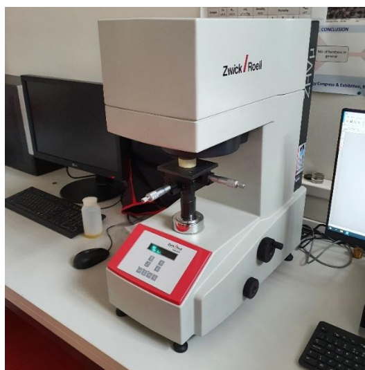
Slika 69. Zwick/Roell ZHV \mu tvrdomjer
