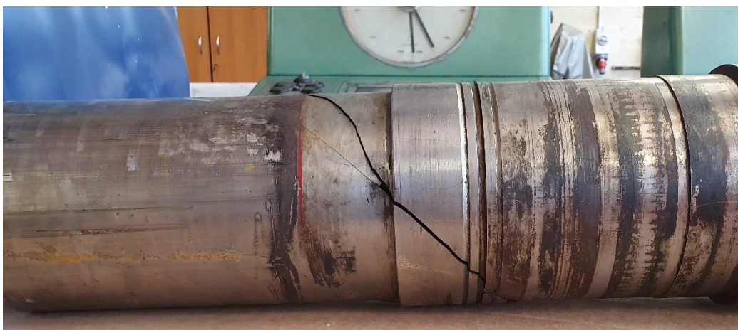
Slika 15. Oštećeno pogonsko vratilo
