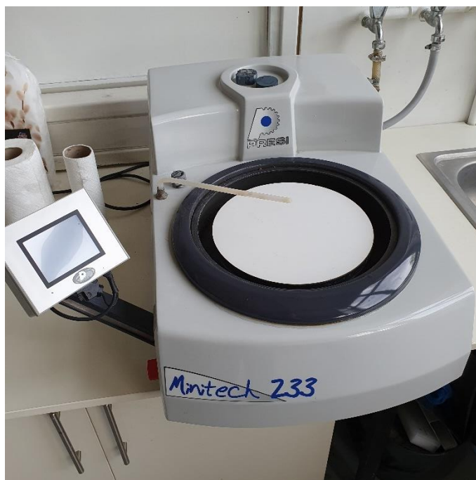
Slika 57. Uređaj za brušenje Presi Minitech 233
