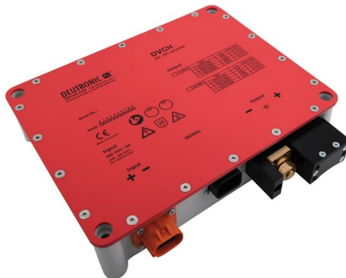
Slika 19. "Buck" DC/DC pretvarač DVCH3003 [18]
