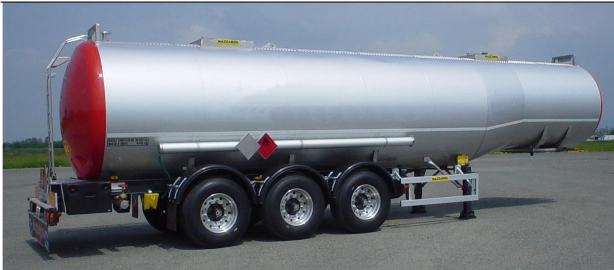
Slika 21. Mobilna cisterna napravljena od dupleks čelika [20]
