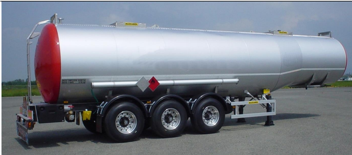
Slika 21. Mobilna cisterna napravljena od dupleks čelika [20]
