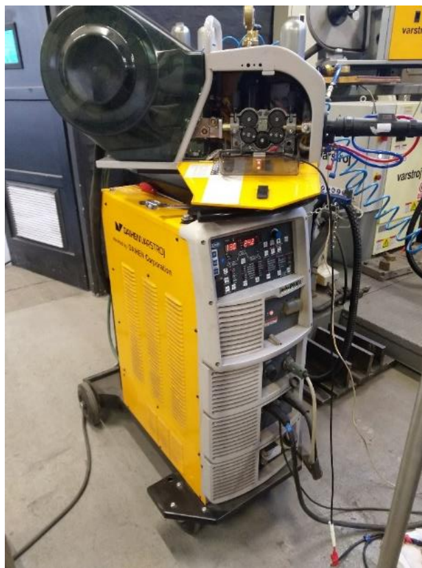
Slika 24. Welbee P500L Daihen Varstroj
