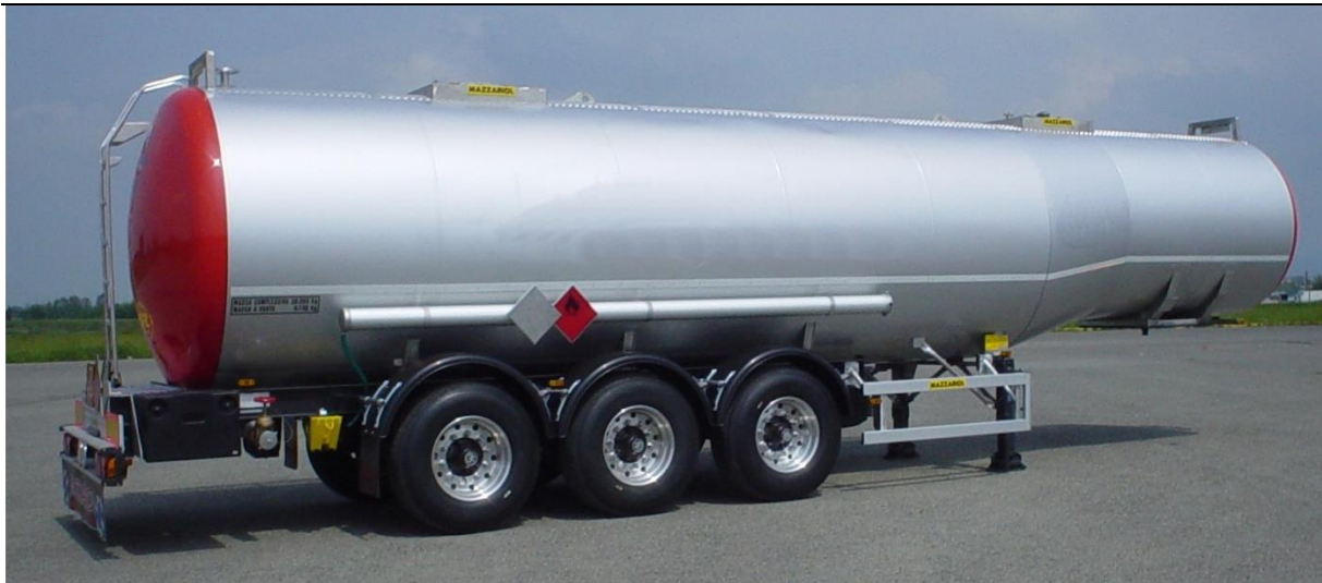
Slika 21. Mobilna cisterna napravljena od dupleks čelika [20]
