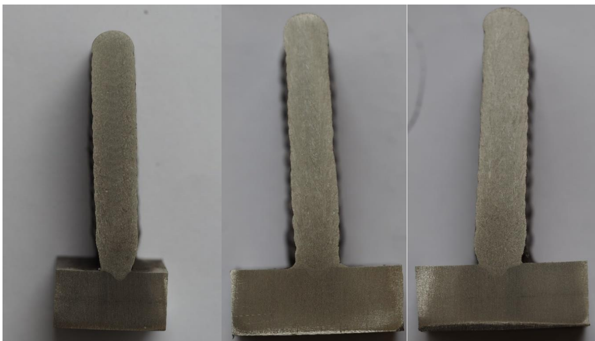
Slika 39. Prikaz makrostrukture za zidove s međuprolaznom temperaturom: lijevo – 50 °C, sredina – 150 °C, desno – 250 °C
