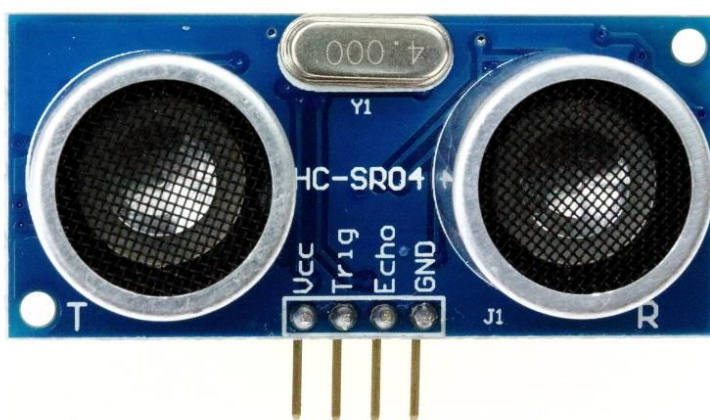
Slika 35. Ultrazvučni senzor HC-SR04 [10]
