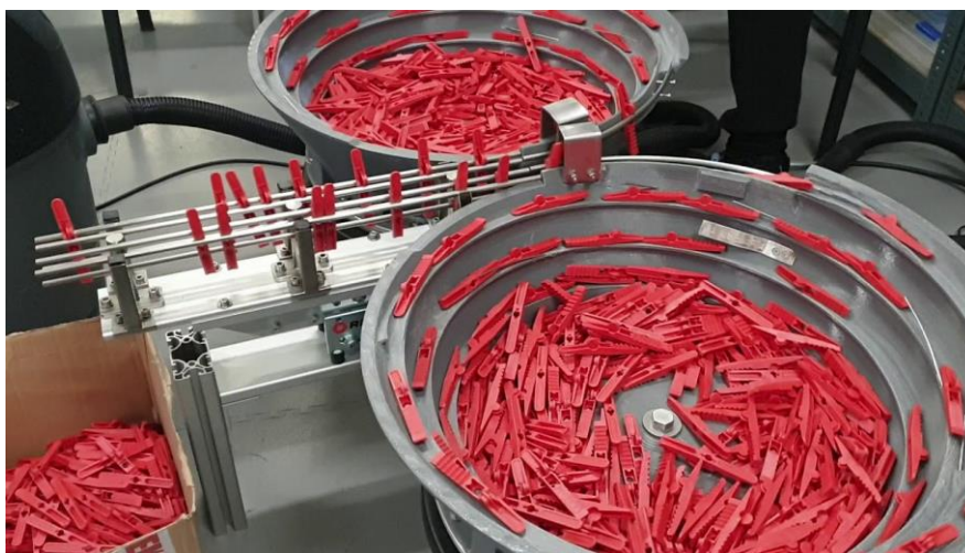
Slika 6. Spiralni vibrododavač polovica štipaljki [4]
