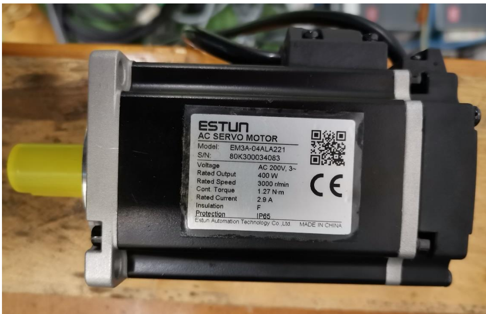
Slika 7. Servomotor ESTUN EM3A-04ALA221 [8]
