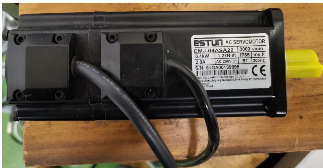
Slika 5. Servomotor ESTUN EMJ-04ASA22 [7]
