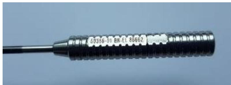
**Slika 53. Prikaz brušenih dijelova biopsijske sonde**
