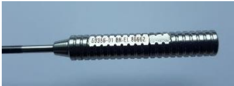
Slika 53. Prikaz brušenih dijelova biopsijske sonde
