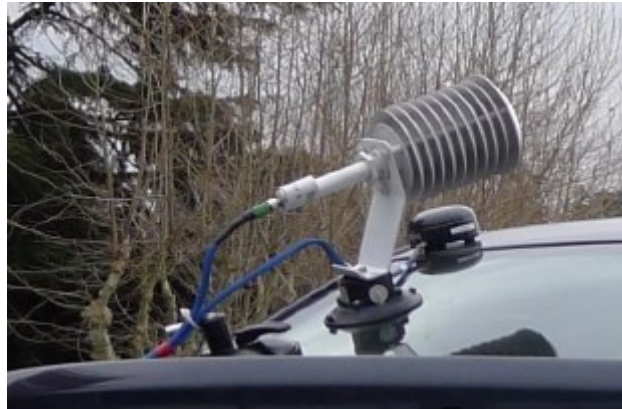
Slika 55. Montirana meteorološka stanica PEMS-a [23]
