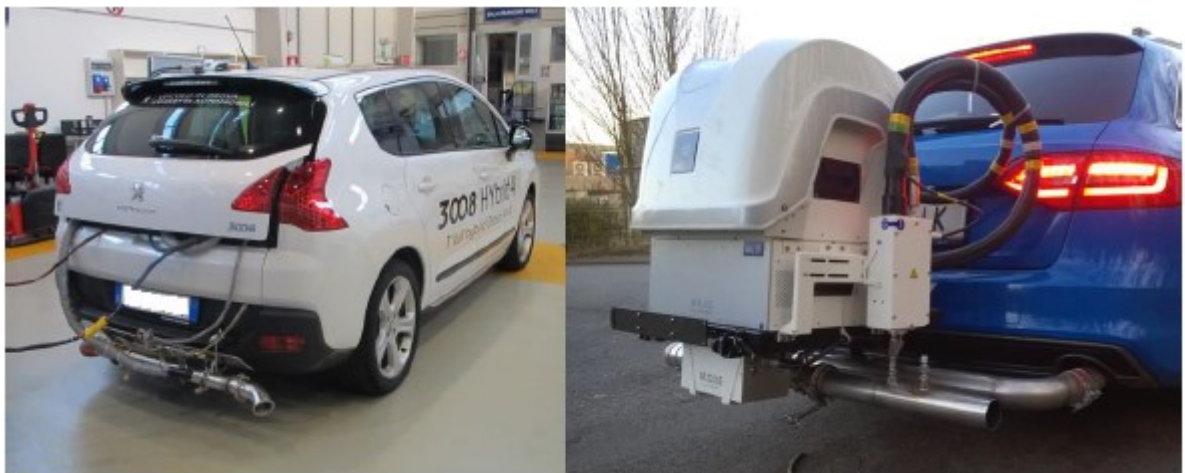
Slika 56. Spajanje grijanog voda za uzorkovanje s PEMS-om [23]
