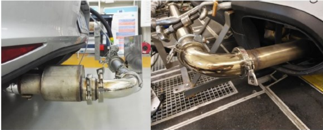
Slika 50. Montirani mjerači masenog protoka ispuha [23]
