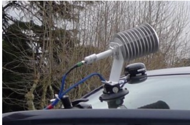
Slika 55. Montirana meteorološka stanica PEMS-a [23]
