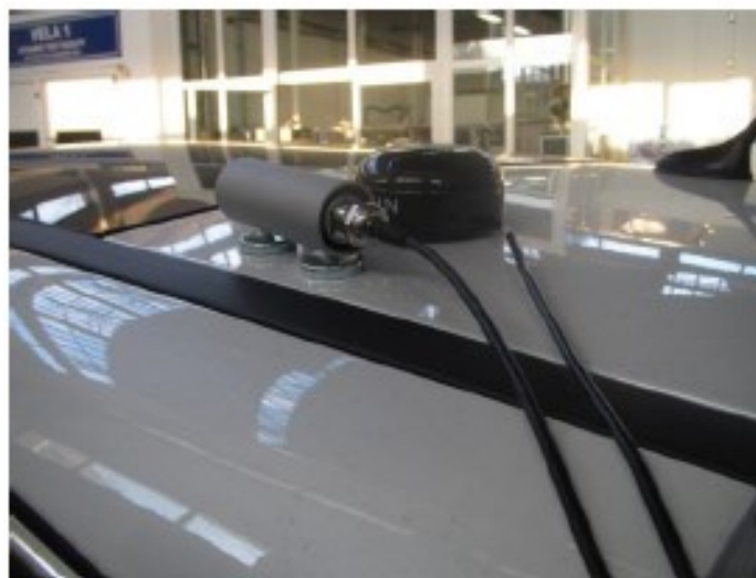
Slika 52. Montirana GPS antena [23]
