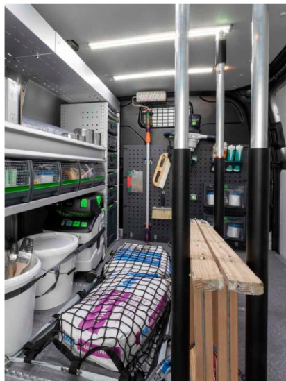
Slika 19. Primjer korištenja teleskopskih šipki za ograničavanje pomaka glomaznog tereta proizvođača bott [3]
