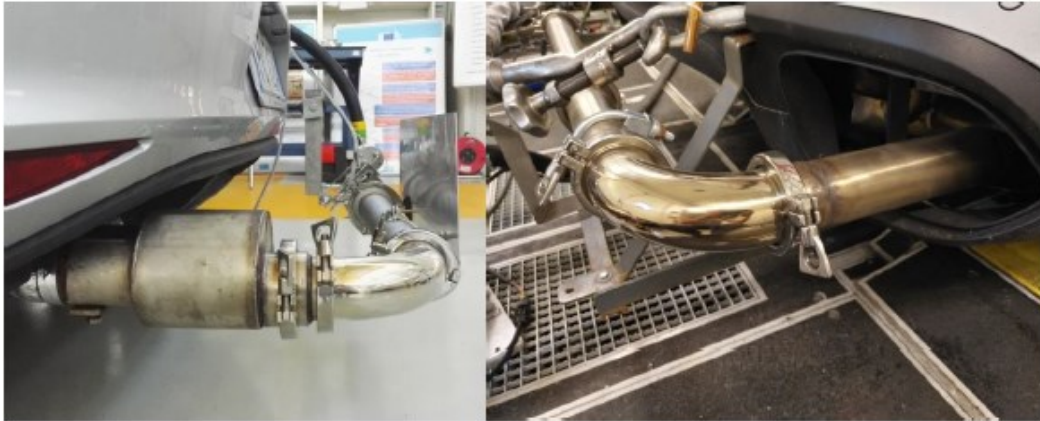
Slika 50. Montirani mjerači masenog protoka ispuha [23]
