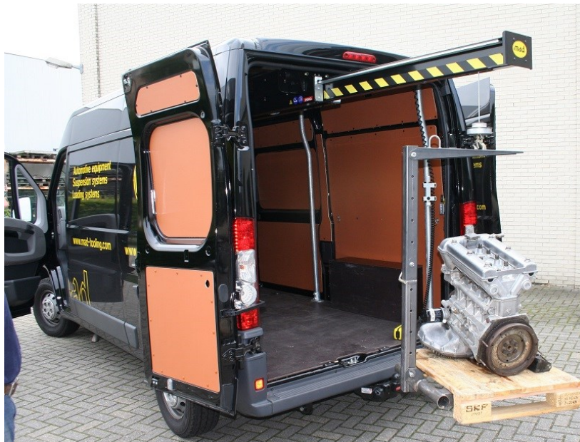
Slika 13. Utovar bloka motora pomoću vitla proizvođača MAD Tooling [7]
