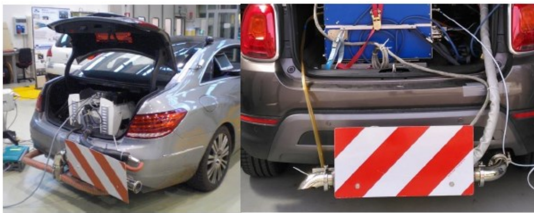
Slika 51. Primjer montaže mjerača masenog protoka ispuha u slučaju da je cijela glavna jedinica unutar vozila [23]
