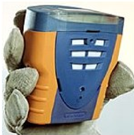
Slika 131. Detektor opasnih plinova Tetra tvrtke Gas Alarm Systems Ltd. [51]
