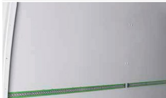
Slika 4. Sidrište ugrađeno na bočne panele proizvođača bott [3]
