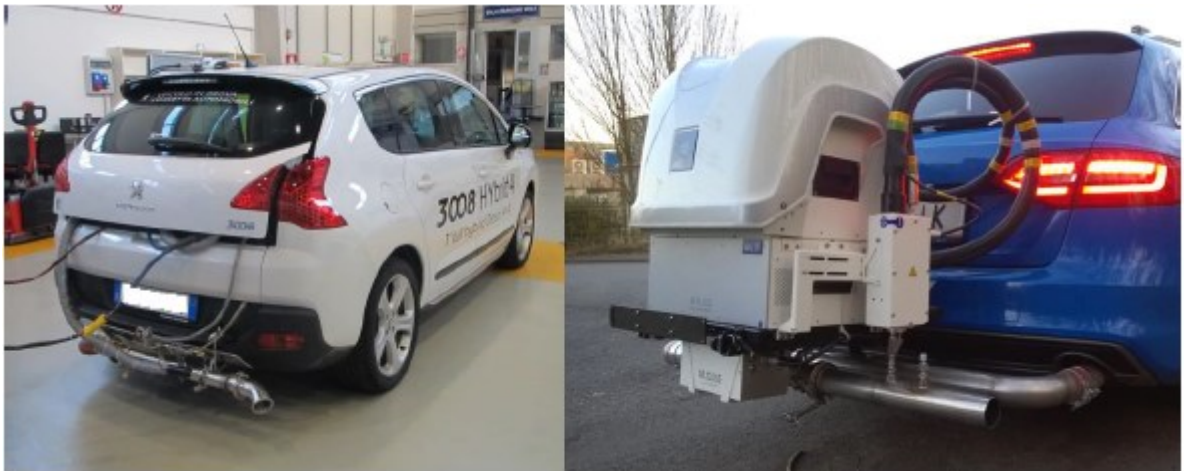
Slika 56. Spajanje grijanog voda za uzorkovanje s PEMS-om [23]
