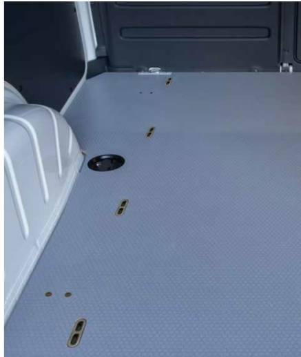
Slika 2. Podnica sa sidrištima proizvođača Sortimo [2]
