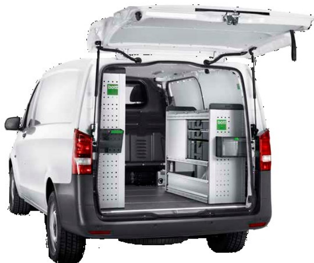
Slika 5. Primjer ugrađenih polica u kombi vozilo proizvođača bott [3]
