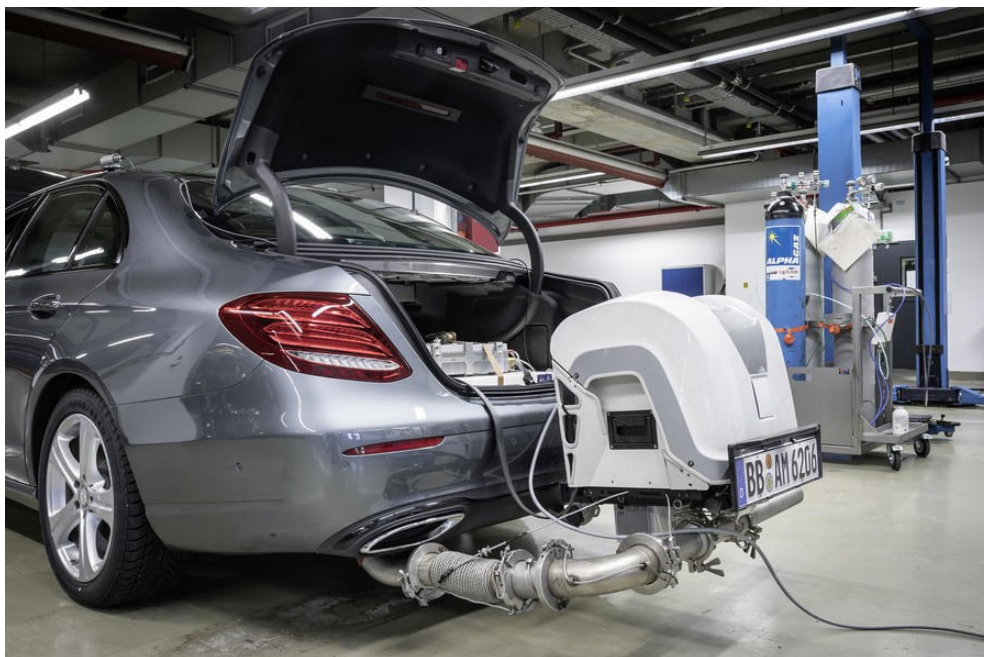
Slika 48. Primjer PEMS-a s elementima montiranim na kuku i elementima u prtljažniku [22]
