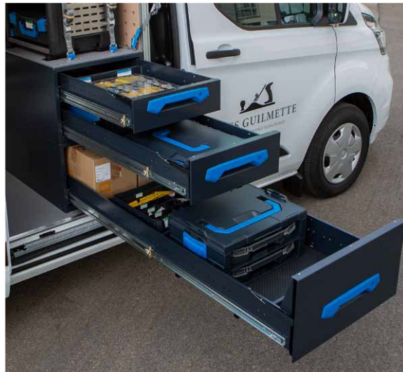
Slika 8. Primjer ladice montirane u vozilo po cijeloj širini proizvođača Sortimo [2]
