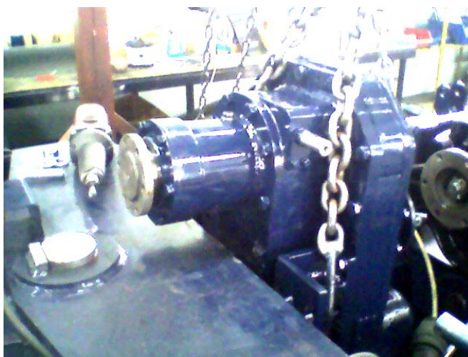
Slika 82: Motaža razvodnika pogona
