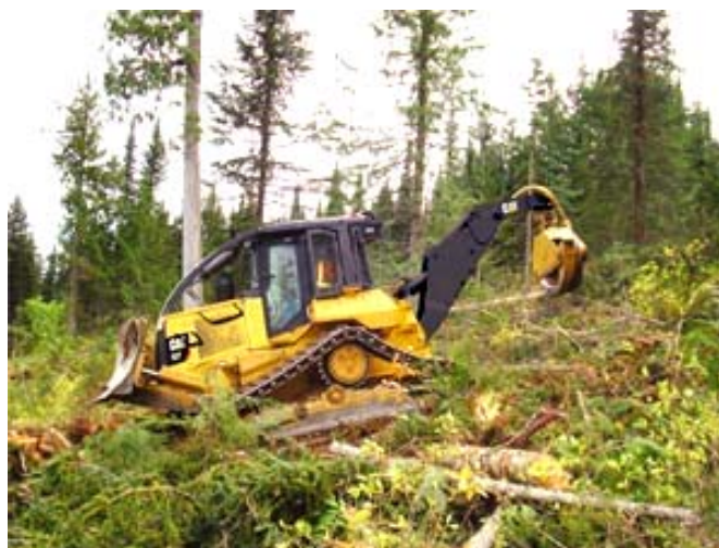
Slika 5: Šumski traktor s gusjenicama
