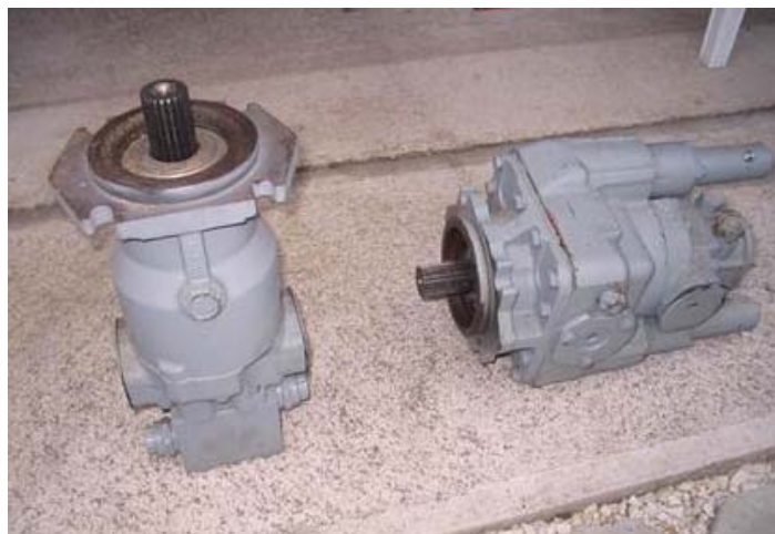
Slika 25: Hidromotor u dosadašnjoj izvedbi traktora
