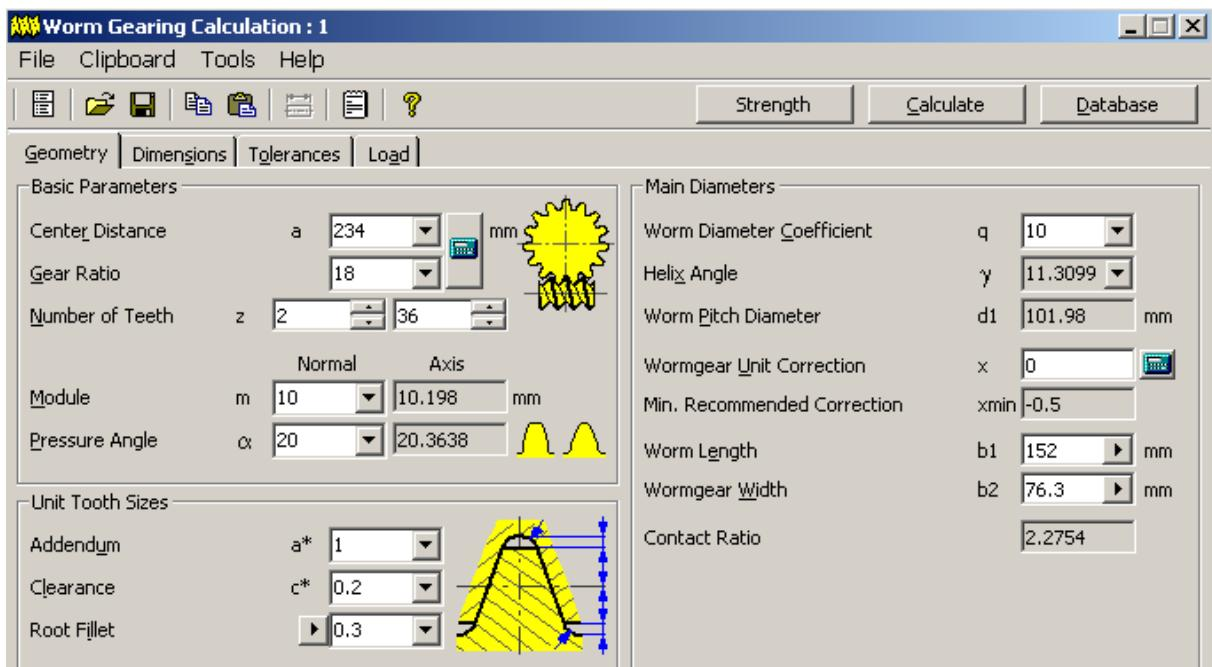
Slika 65: Geometrijski podaci za proračun pužnog reduktora
