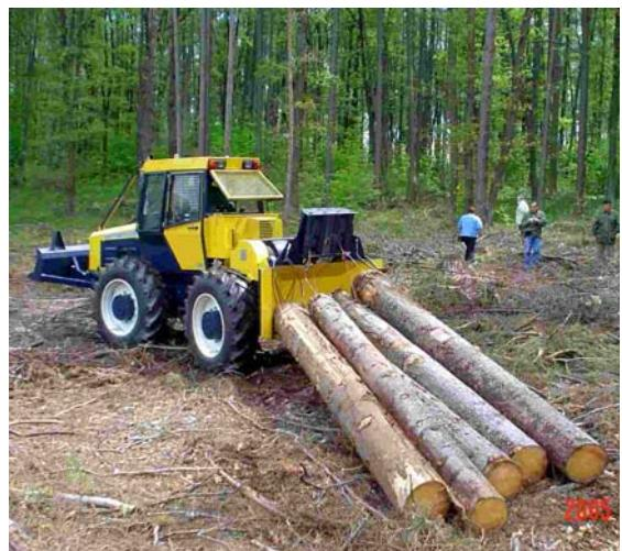
Slika 21: Šumski zglobni traktor EcoTRAC 120V
