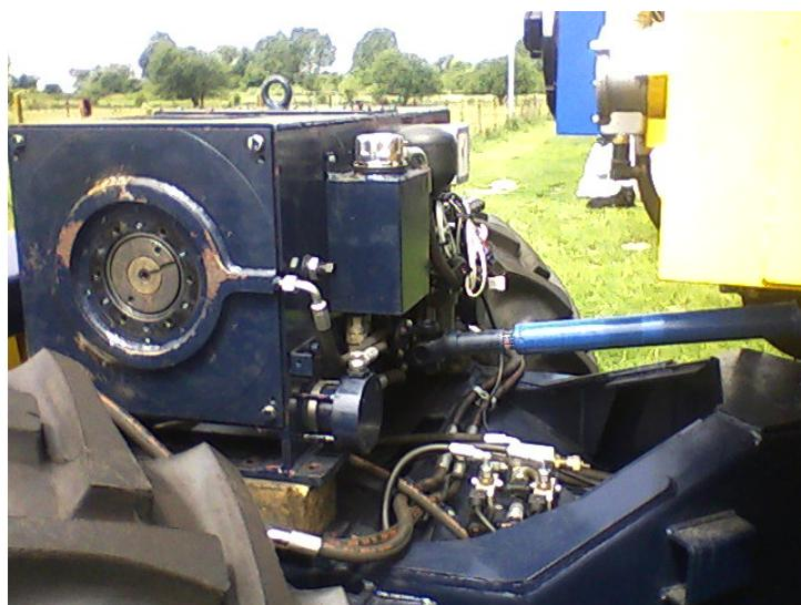
Slika 89: Vitlo – hidraulički sustav i kardansko vratilo
