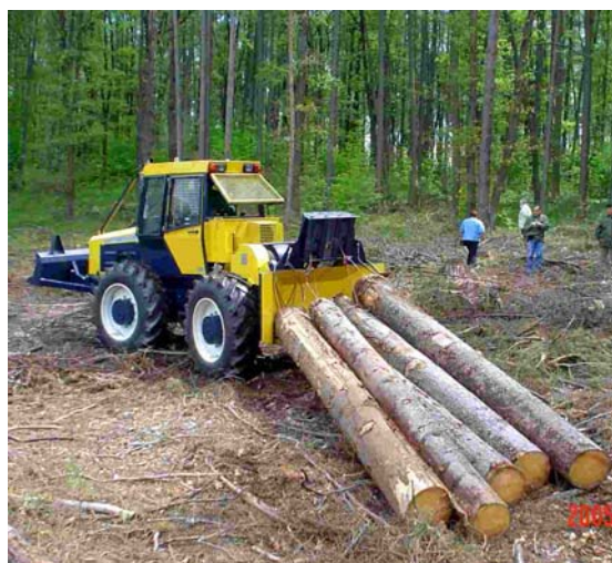
Slika 21: Šumski zglobni traktor EcoTRAC 120V
