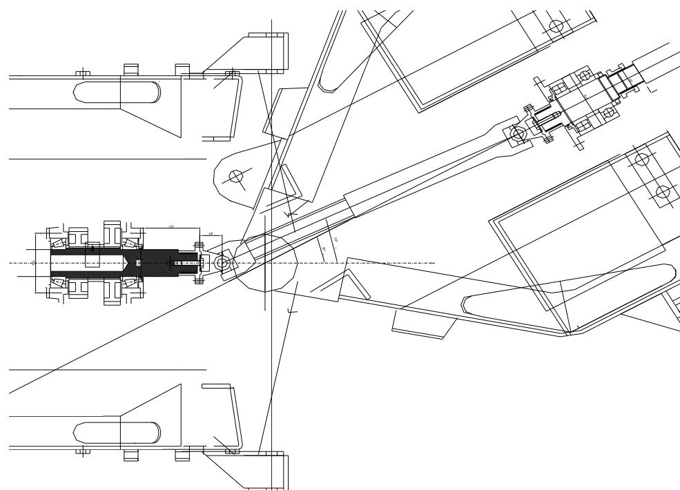
Slika 35: Idejna skica mehaničkog prijenosnika za pogon vitla kod zakrenute šasije -tlocrt
