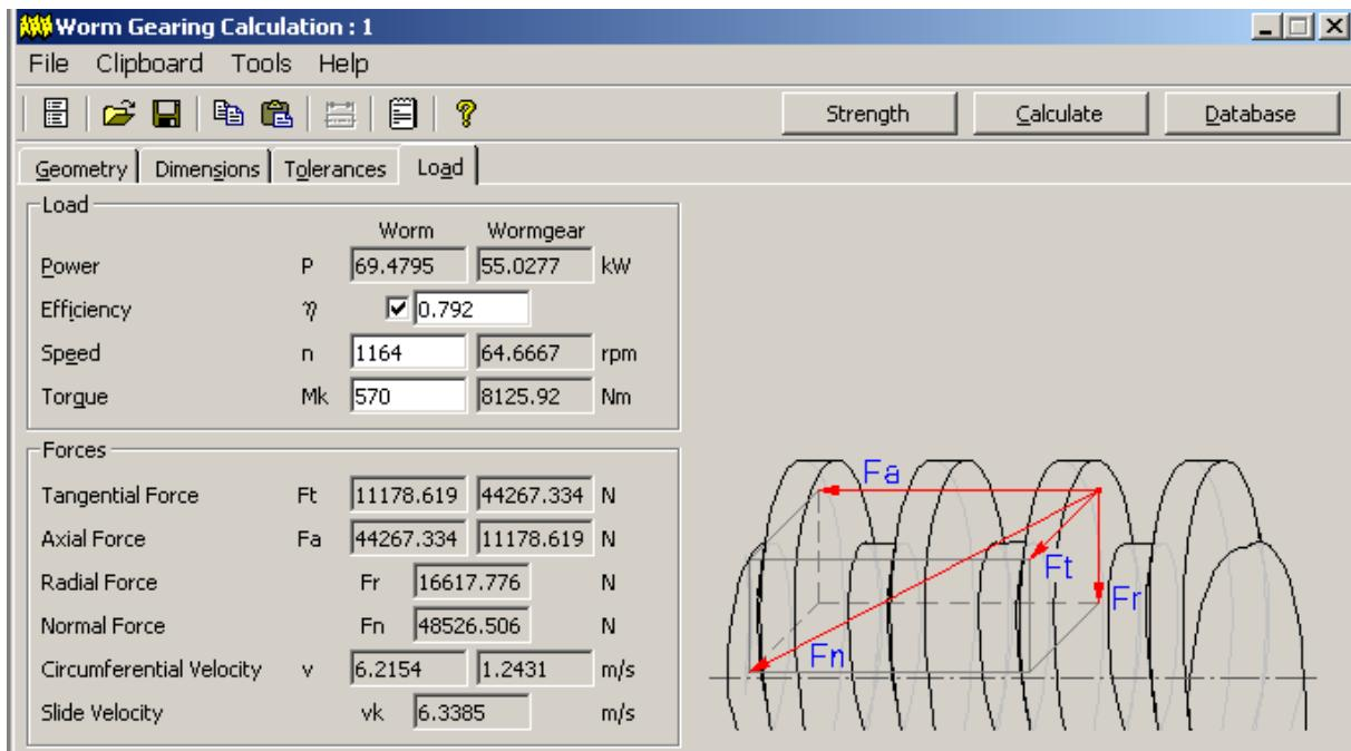
Slika 64: Podaci opterećenja za proračun pužnog reduktora
