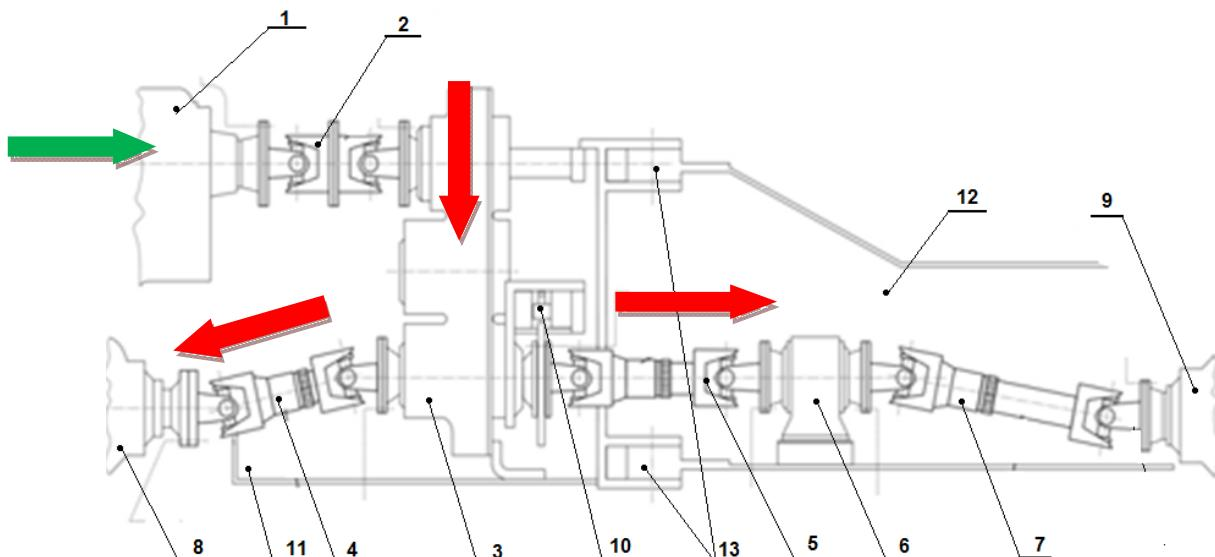
Slika 33: Raspored pogonskog sustava za kretanje traktora
