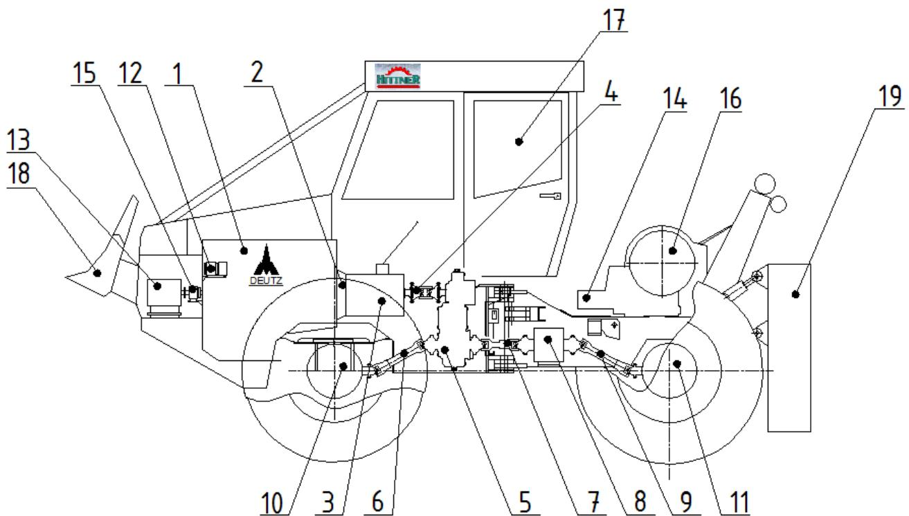
Slika 23: Pogonski sustav šumskog traktora EcoTRAC 120V
