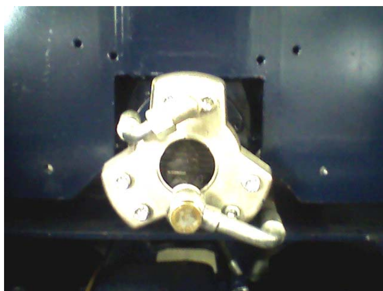
Slika 84: Aksijalna klipna pumpa hidraulike vitla
