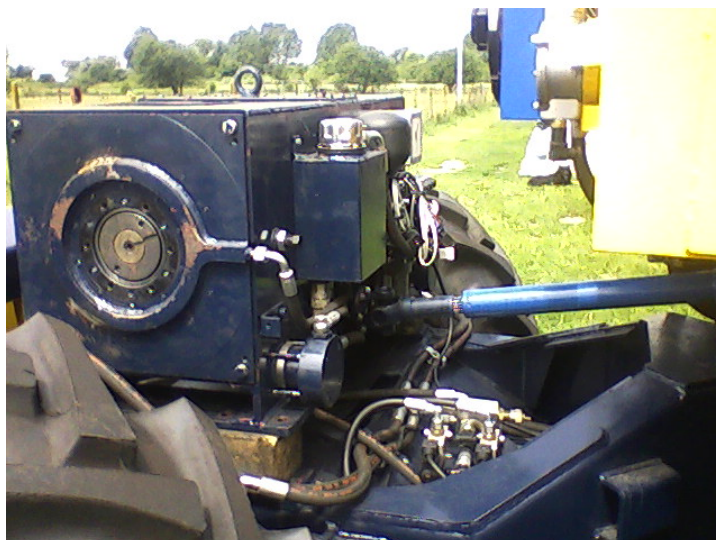
Slika 89: Vitlo – hidraulički sustav i kardansko vratilo
