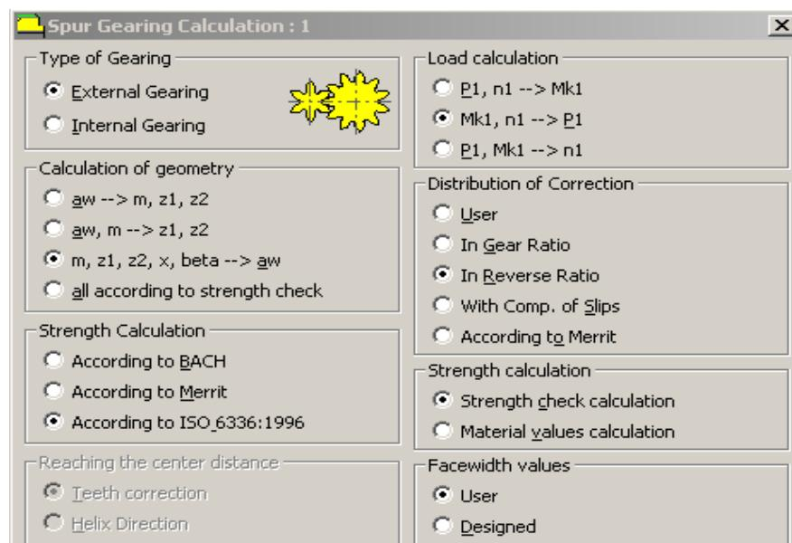
Slika 43: Odabir postavki proračuna čvrstoće zupčanika multiplikatora
