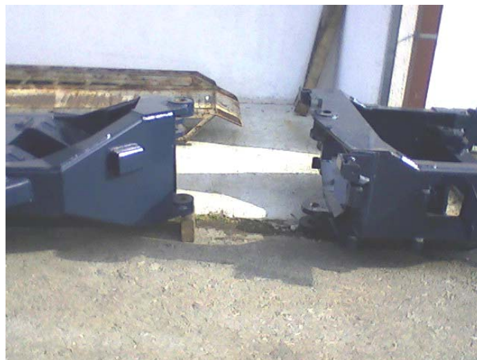
Slika 28: Rastavljena šasija – pogled na vertikalni zglob
