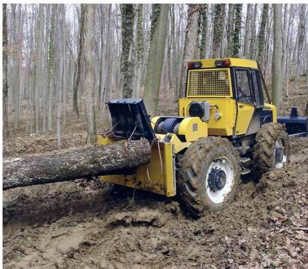
Slika 20: Šumski zglobni traktor EcoTRAC 120V
