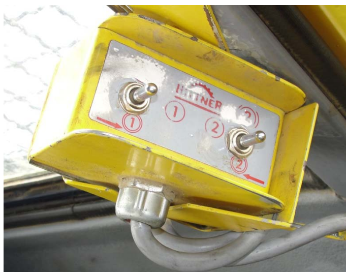
Slika 99: Novorazvijeni traktor EcoTRAC 120MV – upravljanje elektrohidrauličkim sustavom vitla
