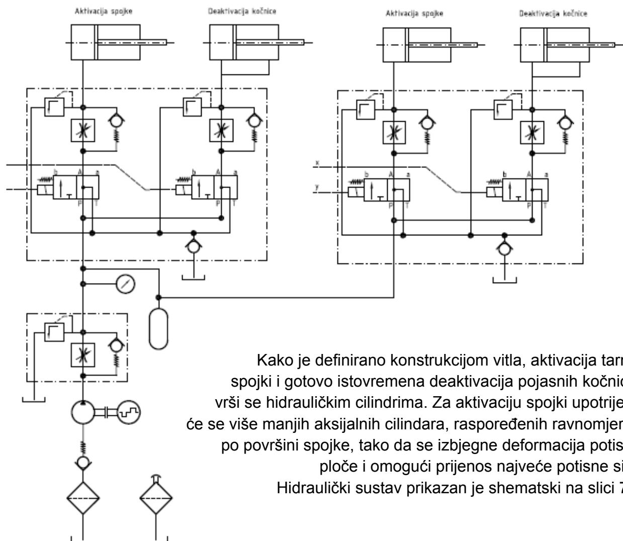
Kako je definirano konstrukcijom vitla, aktivacija tarnih spojki i gotovo istovremena deaktivacija pojasnih kočnica, vrši se hidrauličkim cilindrima. Za aktivaciju spojki upotrijebit će se više manjih aksijalnih cilindara, raspoređenih ravnomjerno po površini spojke, tako da se izbjegne deformacija potisne ploče i omogući prijenos najveće potisne sile. Hidraulički sustav prikazan je shematski na slici 72.
