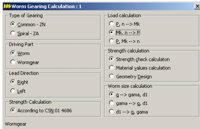
Slika 66: Parametri proračuna pužnog reduktora
