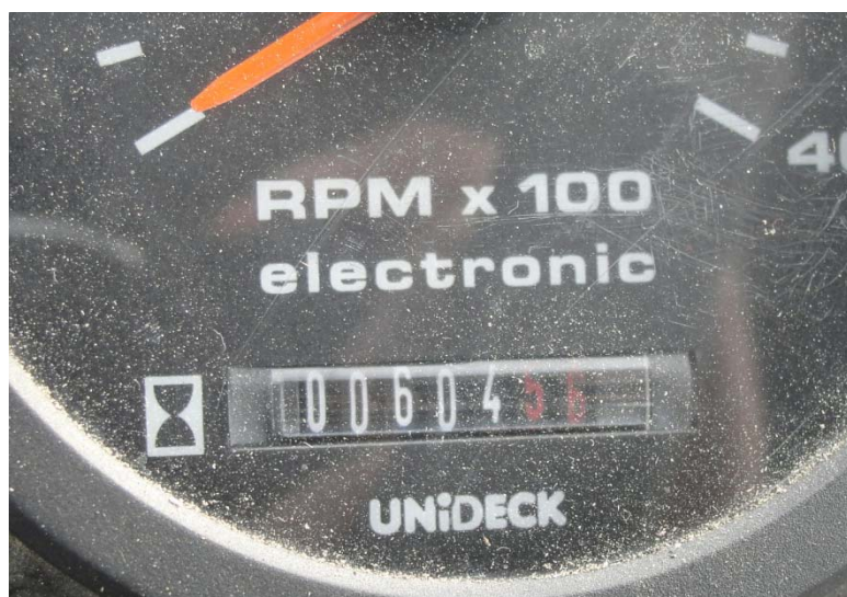
Slika 97: Novorazvijeni traktor EcoTRAC 120MV –pokazivač odrađenog vremena
