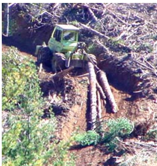
Slika 13: Šumski traktor vuče trupce pomoću užadi
