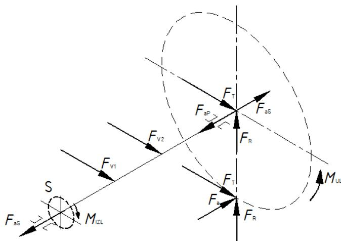
Slika 75: Opterećenje bubanjskog vratila
