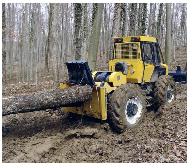
Slika 20: Šumski zglobni traktor EcoTRAC 120V
