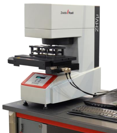
Slika 18. ZHV \mu tvrdomjer [16]
