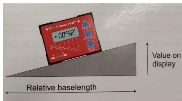
Slika 16. Princip rada klinamometra
