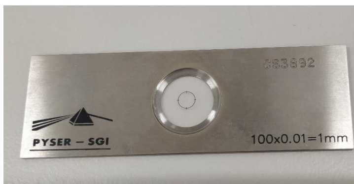
Slika 31. Staklena mjerna skala 1 mm
