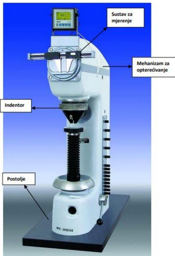
Slika 11. Komponente tvrdomjera [10]
