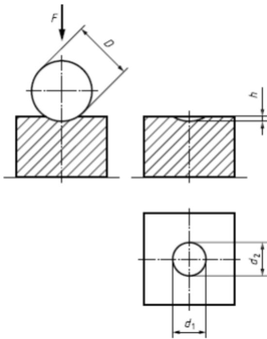
**Slika 4. Brinellova metoda mjerena tvrdoće**
