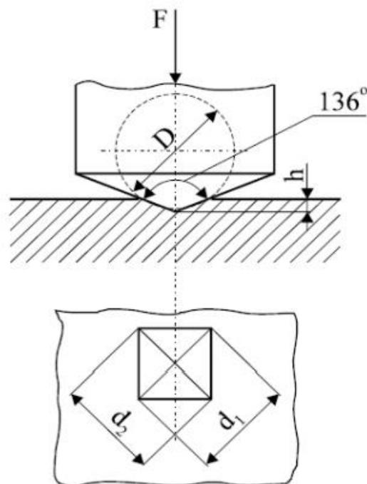
**Slika 9. Postupak mjerjenja tvrdoće po Vickersu**
