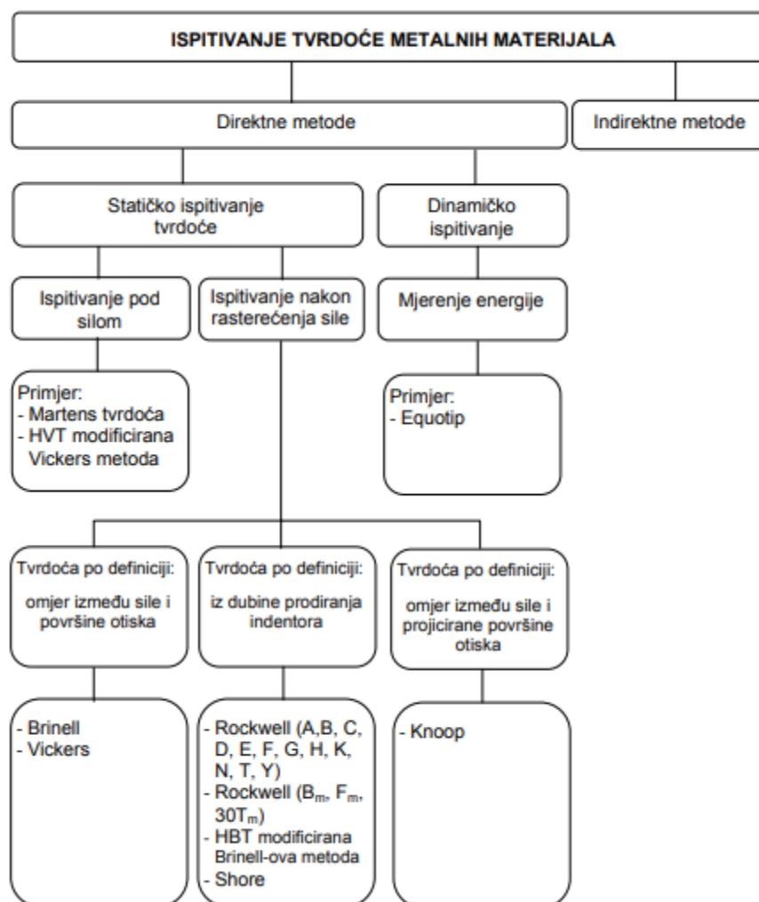
Slika 2. Metode za ispitivanje tvrdoće metalnih materijala [3]
