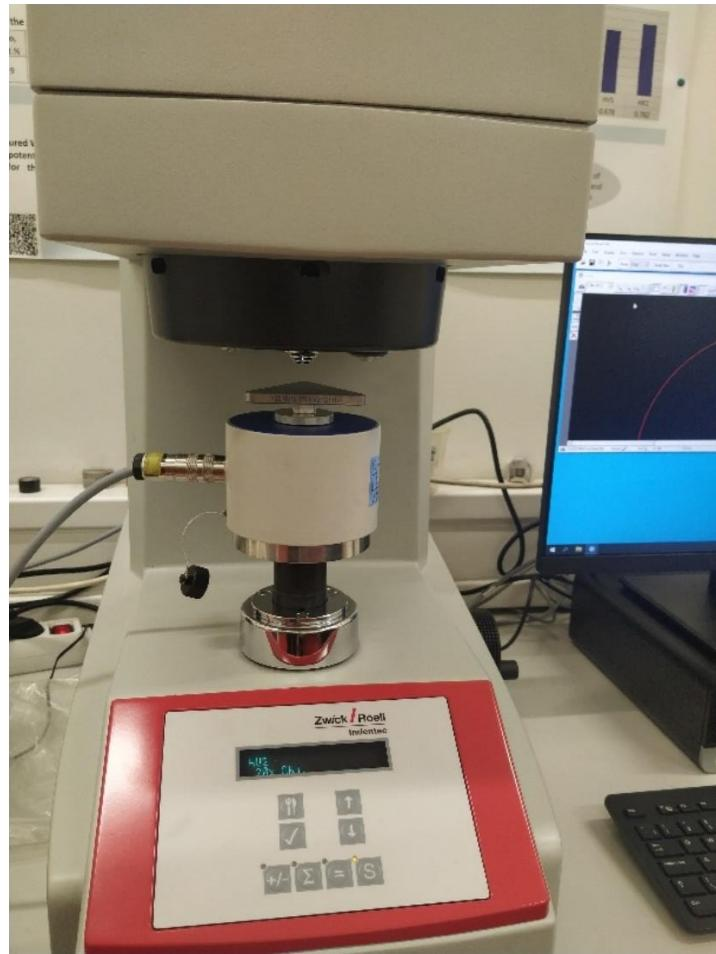
**Slika 25. Dinamometar postavljen na stolić s etalonskom pločicom**
