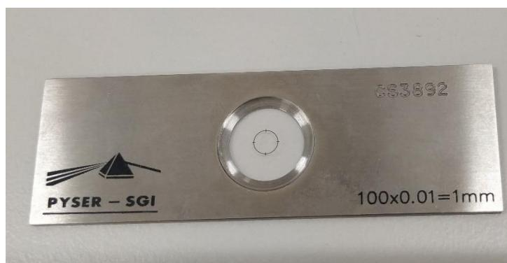
**Slika 31. Staklena mjerna skala 1 mm**
