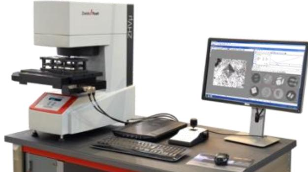
**Slika 19. ZHV $\mu$  tvrdomjer postavljen s računalom [16]**
