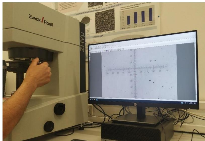
Slika 32. Proses provjere sustava za očitavanje veličine otiska
