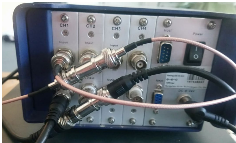
Slika 13. Prikaz spajanja na pojačalo naboja
