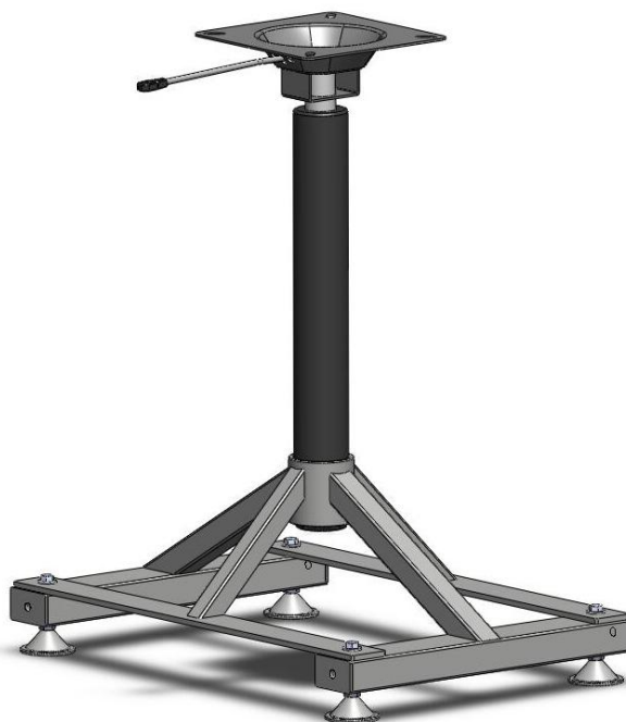
Slika 9.9 Postolje, cilindar i mehanizam sa ručicom
