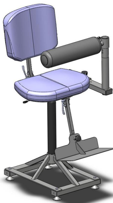
Slika 9.1 Konceptualni model sjedala
