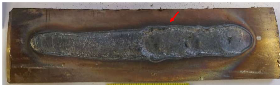
Slika 23. Poroznost na licu navara uzorka 5
