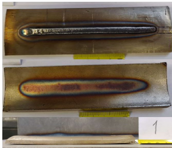
Slika 15. Uzorak 1 ( I = 75 \text{ A} , U = 12,5 \text{ V} )
