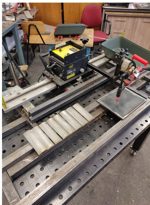
Slika 12. "BUG-O systems" automat za zavarivanje
