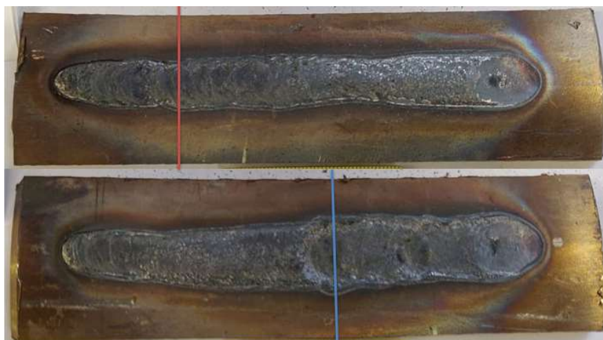
Slika 20. Mjesta rezanja uzoraka
