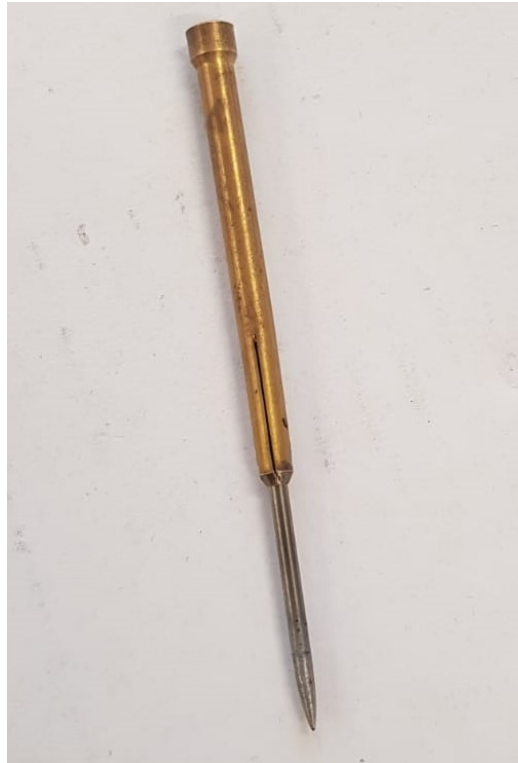
Slika 10. Volframova netaljiva elektroda
