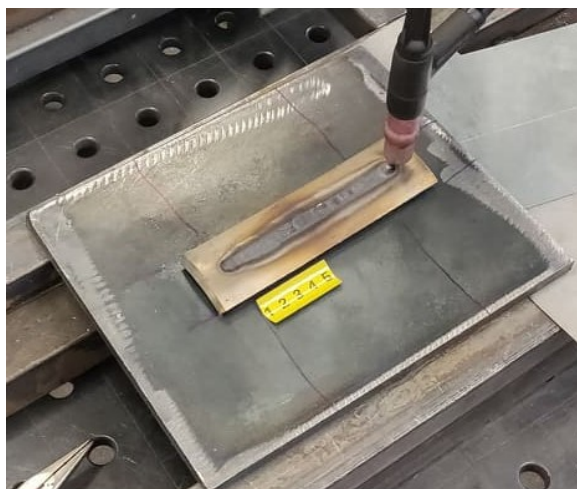
Slika 13. Izgled uzorka neposredno nakon navarivanja
