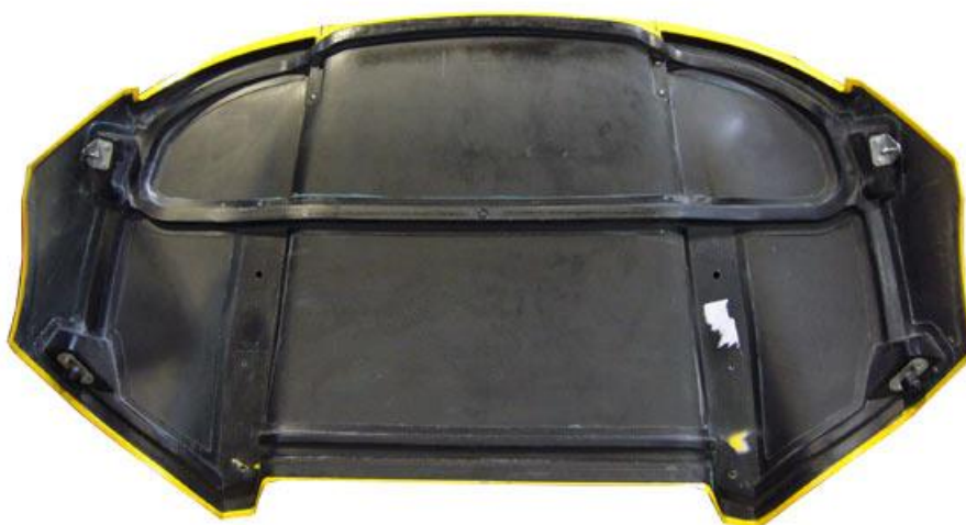
Slika 21. Konstrukcija donje strane prtljažnika u Tesla Roadsteru od ugljičnih vlakana [21]
