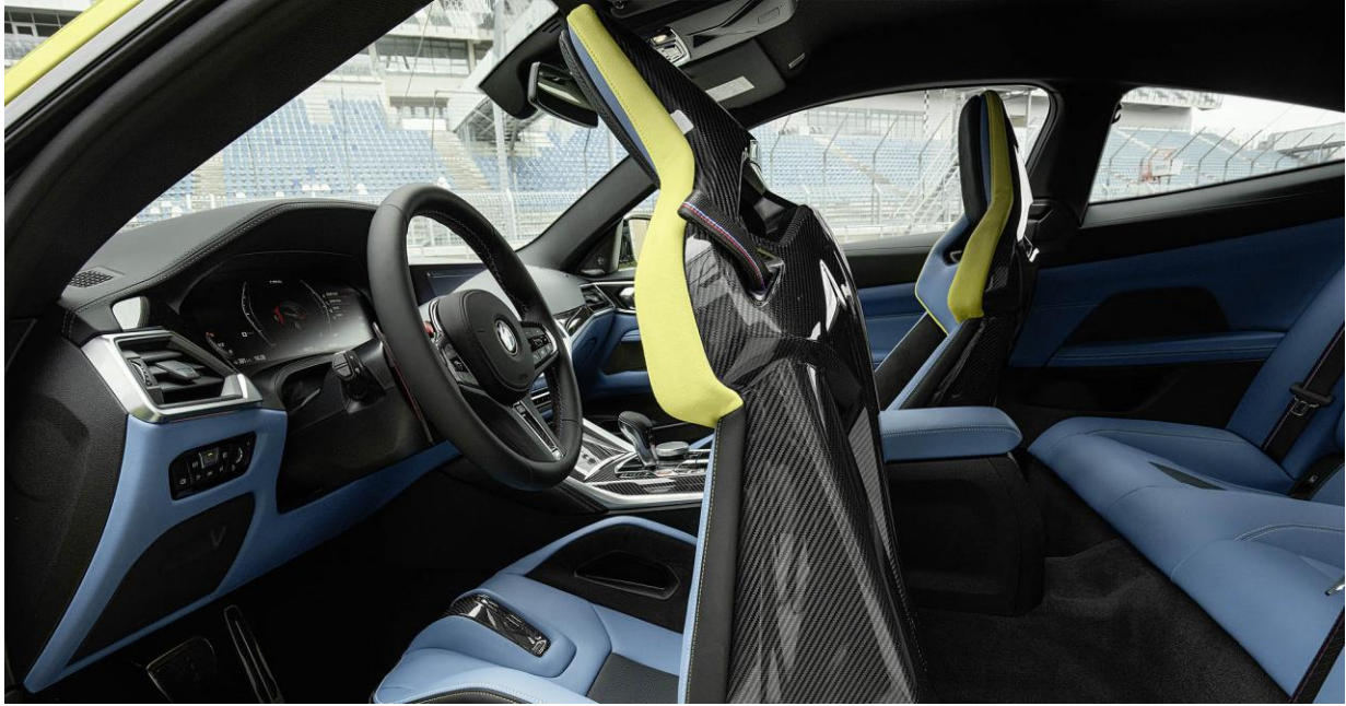
Slika 40. Okvir sjedala BMW-a M4 G82 napravljen od CFRP-a [27]
