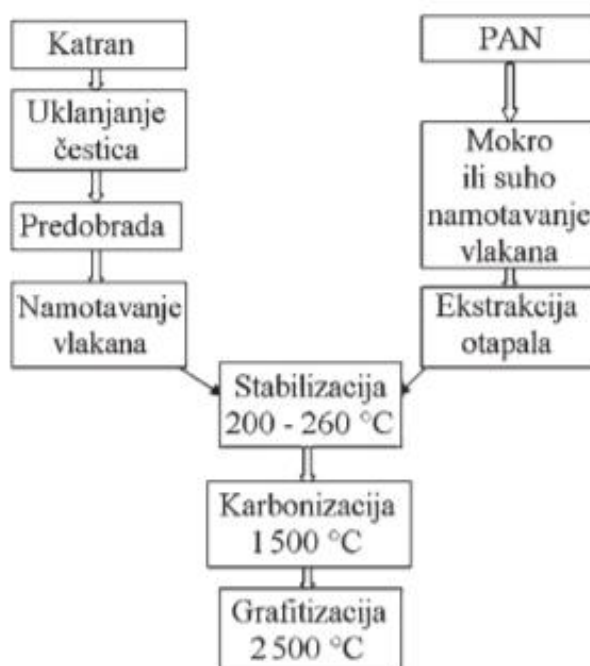
Slika 19. Prikaz usporedbe proizvodnje ugljičnih vlakana iz PAN-a i katrana [12]
