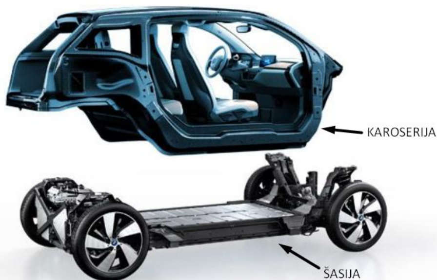
Slika 32. Šasija i karoserija BMW i3 automobila [22]
