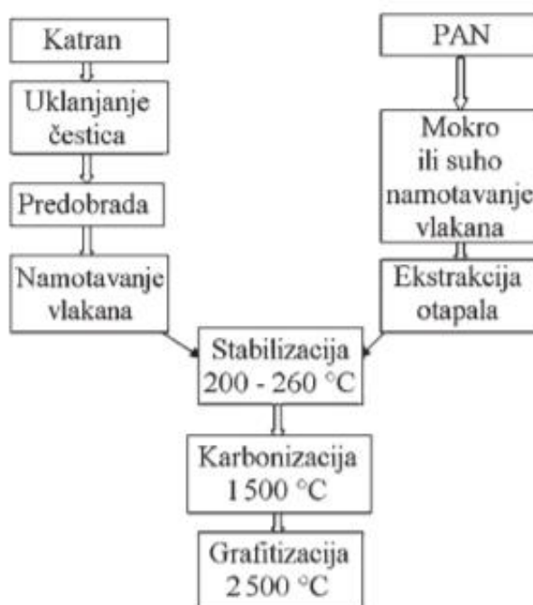
Slika 19. Prikaz usporedbe proizvodnje ugljičnih vlakana iz PAN-a i katrana [12]
