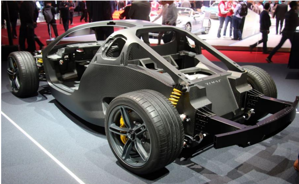
Slika 30. Monokok karoserija automobila Rimac C_Two napravljen od CFRP-a [19]
