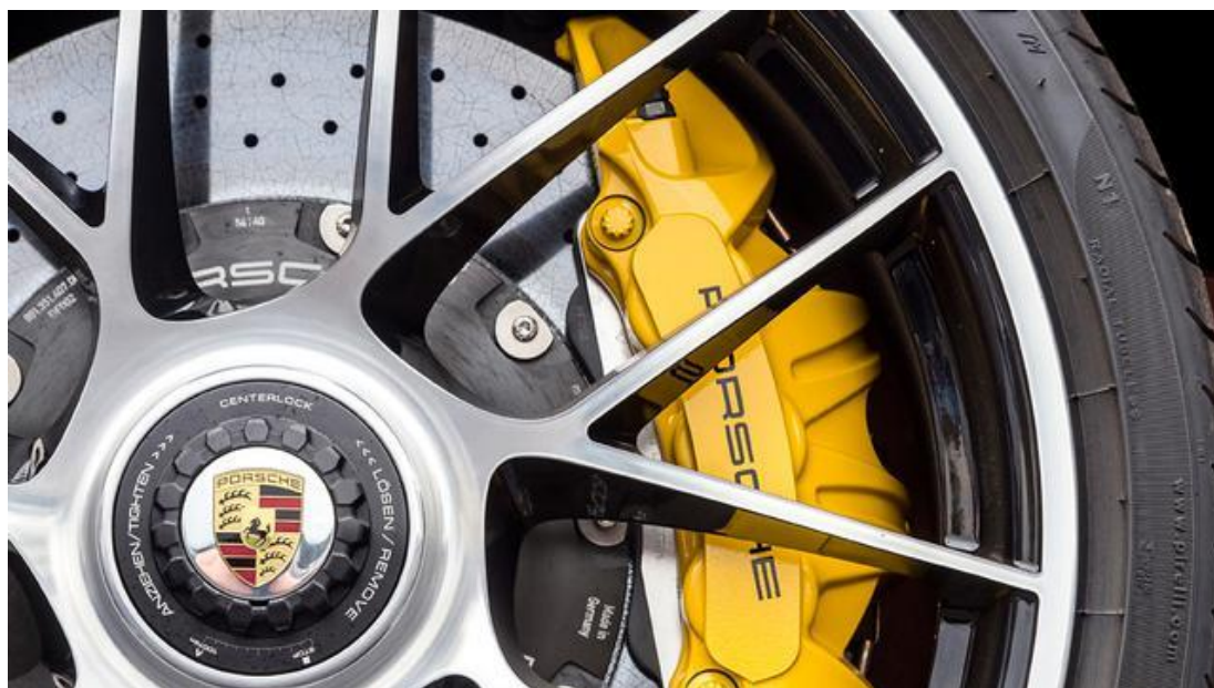
Slika 7. Kočni diskovi Porsche-a 911 Turbo napravljeni od kompozita sa SiC matricom ojačanom ugljičnim vlaknima [11]
