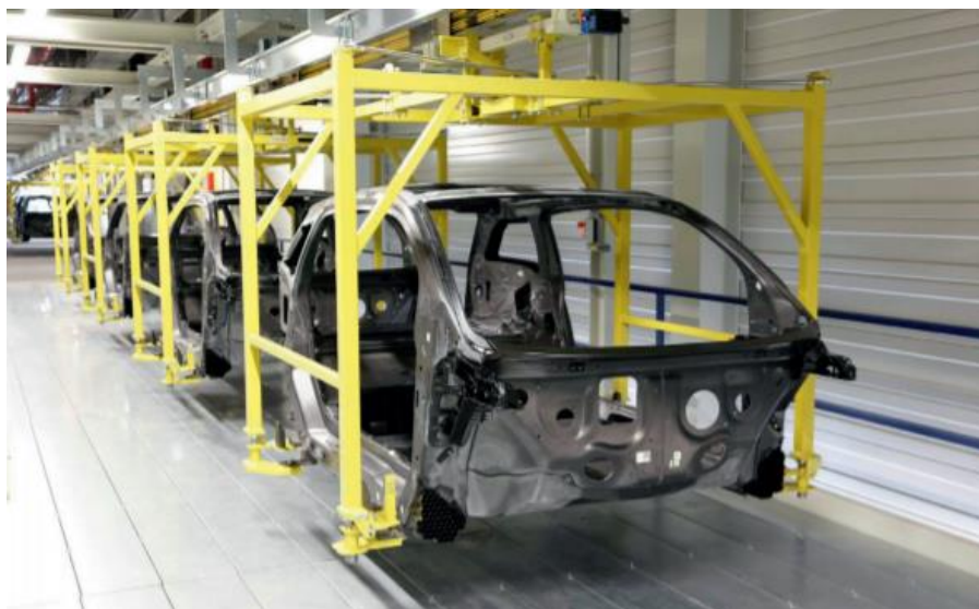
Slika 33. Automatizirana proizvodnja karoserije BMW i3 od CFRP-a u Leipzigu [21]
