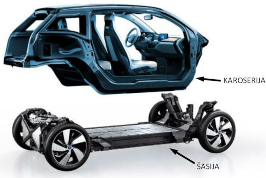
Slika 32. Šasija i karoserija BMW i3 automobila [22]
