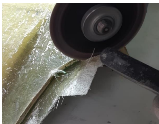
a) rezanje rubova kalupa
