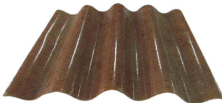
Slika 6. Krov s ojačalom od bambusa [13]
