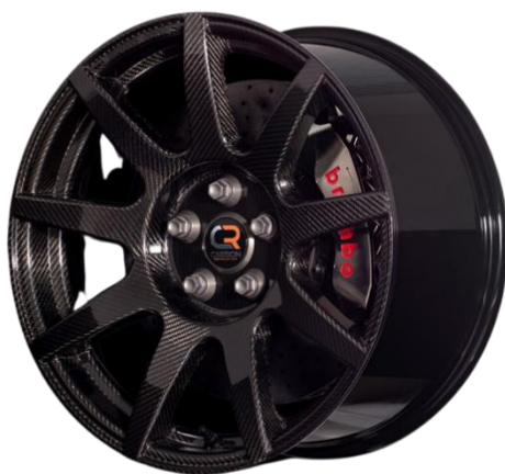
Slika 10. Naplatak od kompozita [18]
