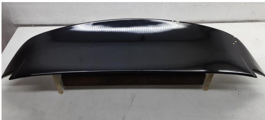
Slika 21. Prototip produženog spojlera za Hondu Civic EG
