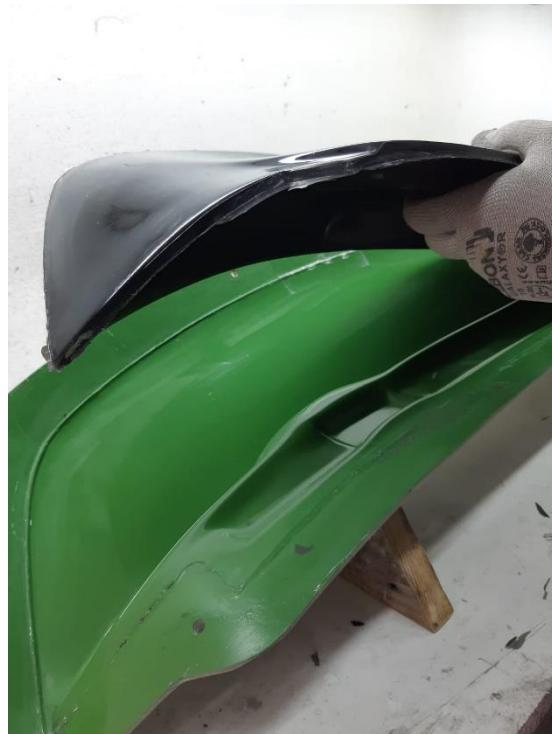
Slika 42. Vađenje spojlera iz kalupa
