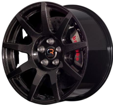
**Slika 10. Naplatak od kompozita [18]**
