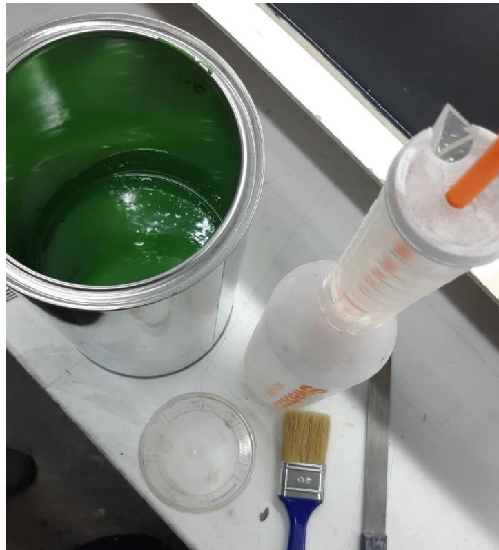
**Slika 27. Korišteni materijali i alati za nanošenje gel-premaza**
