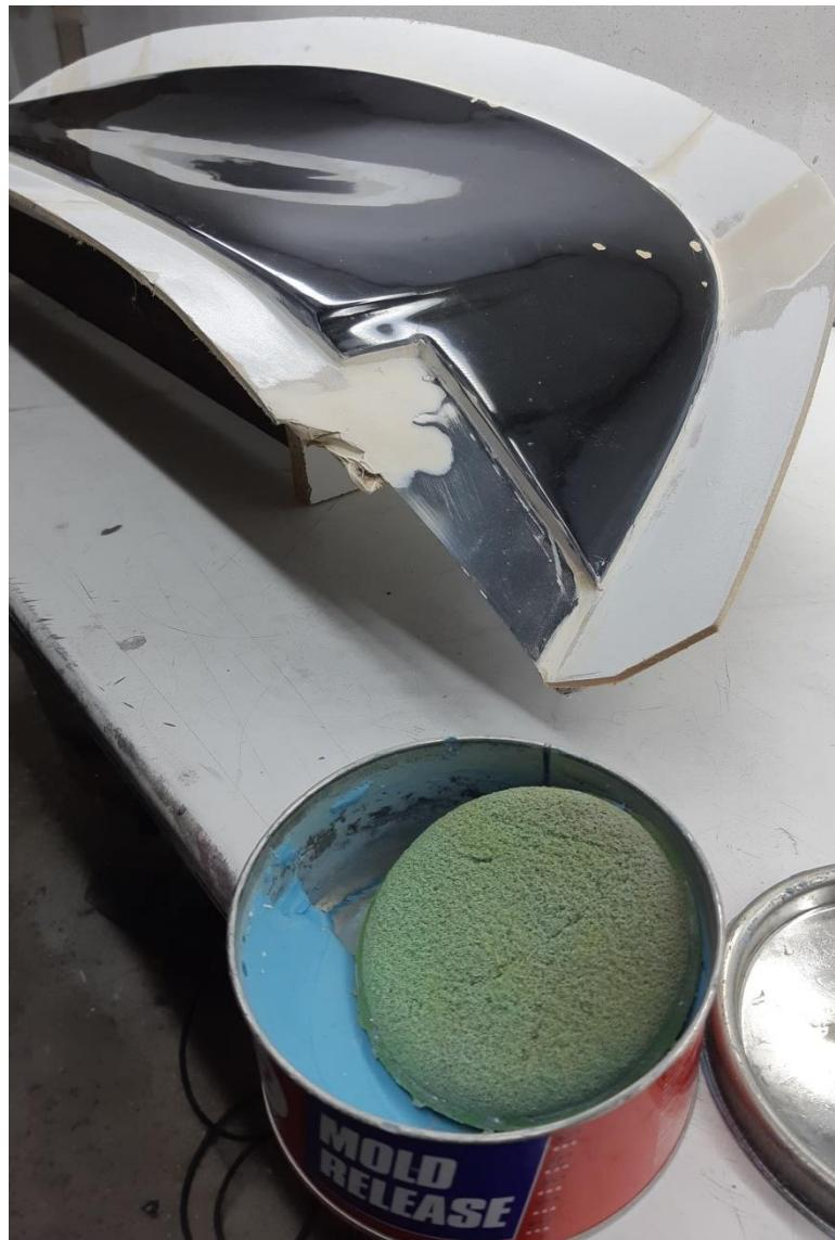
Slika 26. Nanošenje voska na gornju površinu spojlera
