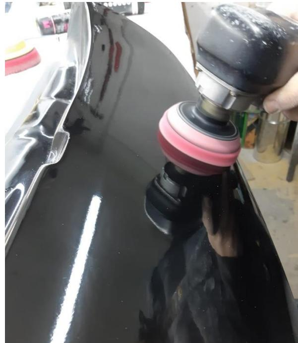
**Slika 43. Poliranje spojlera uređajem za poliranje**
