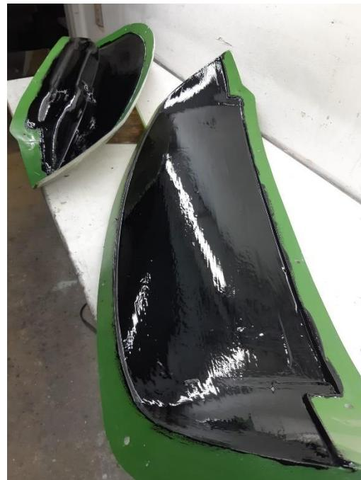
Slika 37. Nanošenje crnog gel premaza na kalup
