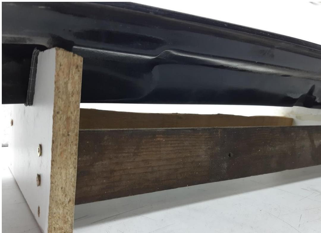
**Slika 23. Naprava za pričvršćivanje prototipnog spojlera tijekom rada**
