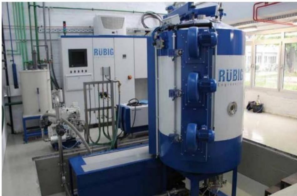
Slika 9. PACVD uređaj tvrtke RÜBIG instaliran na Fakultetu strojarstva i brodogradnje[8]
