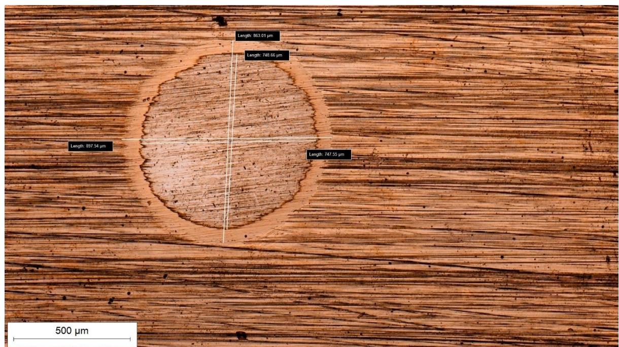
Slika 37. Trag trošenja na čeliku K390 MC snimljen na svjetlosnom mikroskopu nakon ispitivanja debljine prevlake metodom utiskivanja kuglice na uzorku C3 s TiN/TiBN prevlakom
