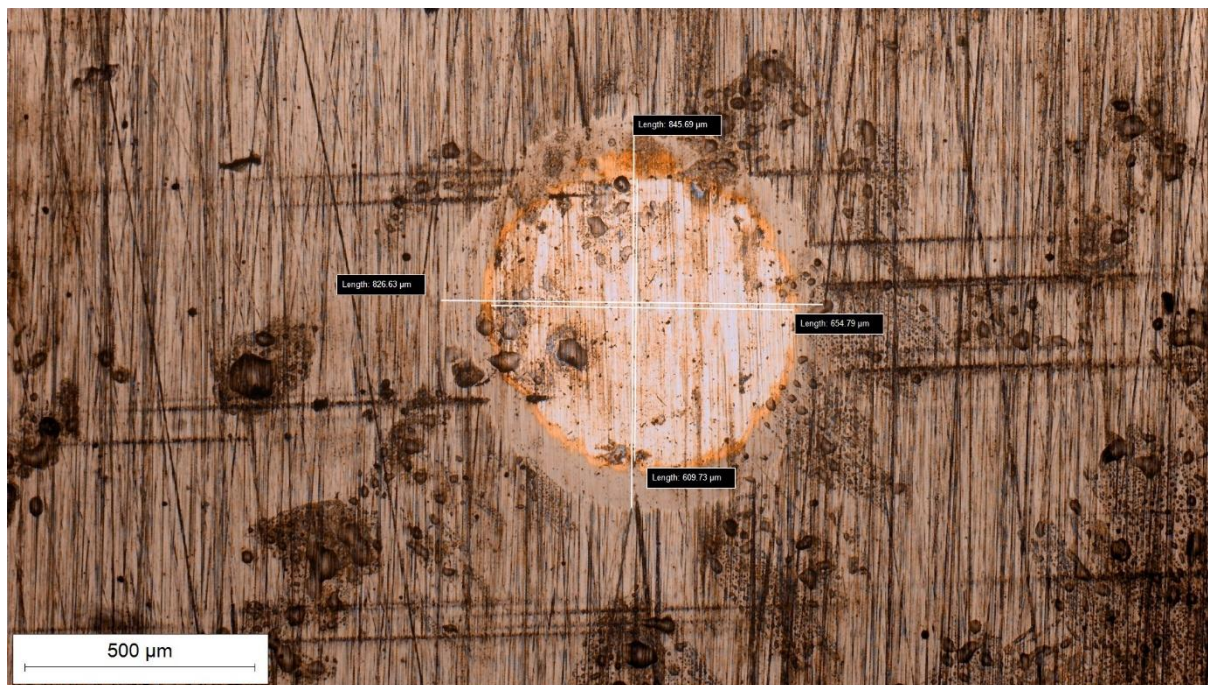
Prilog 2.3. Trag trošenja na čeliku K390 snimljen na svjetlosnom mikroskopu nakon ispitivanja debljine prevlake metodom utiskivanja kuglice na uzorku C2 s TiN/TiCN prevlakom
