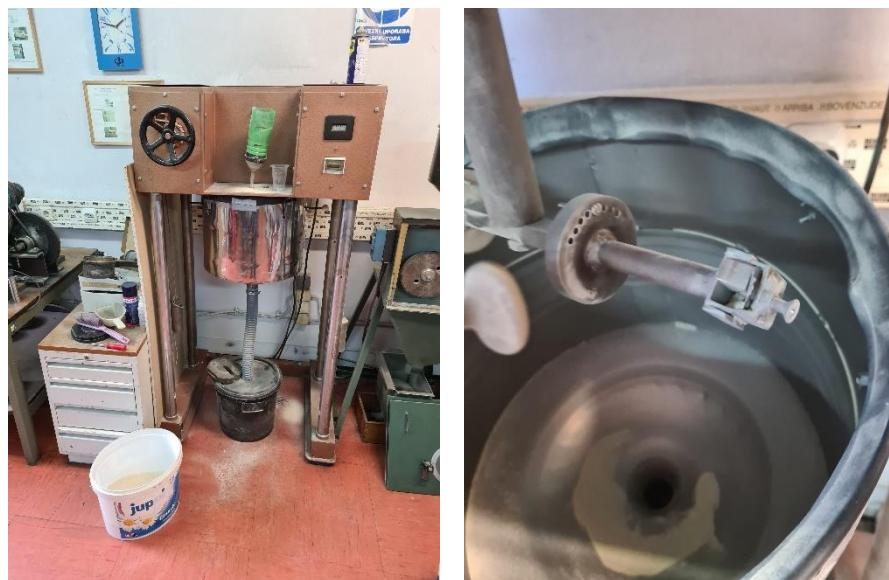
Slika 23. Uredaj za ispitivanje otpornosti na eroziju; a) izgled uređaja, b) uzorak u držaču
