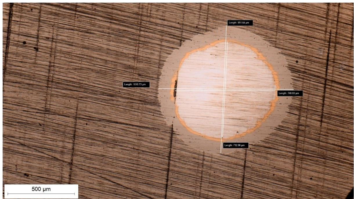
Slika 36. Trag trošenja na čeliku K390 MC snimljen na svjetlosnom mikroskopu nakon ispitivanja debljine prevlake metodom utiskivanja kuglice na uzorku C2 s TiN/TiCN prevlakom
