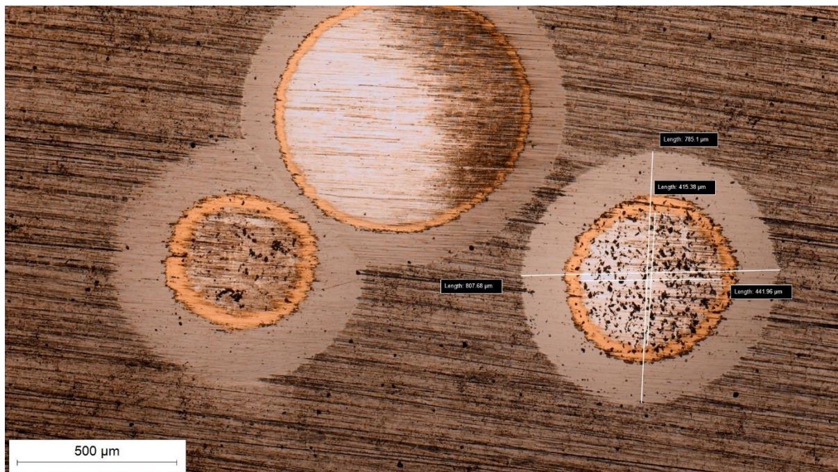
Prilog 2.1. Trag trošenja na čeliku K110 snimljen na svjetlosnom mikroskopu nakon ispitivanja debljine prevlake metodom utiskivanja kuglice na uzorku D2 s TiN/TiCN prevlakom
