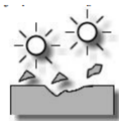
Slika 52. Shema tribosustava kavitacijske erozije [1].
