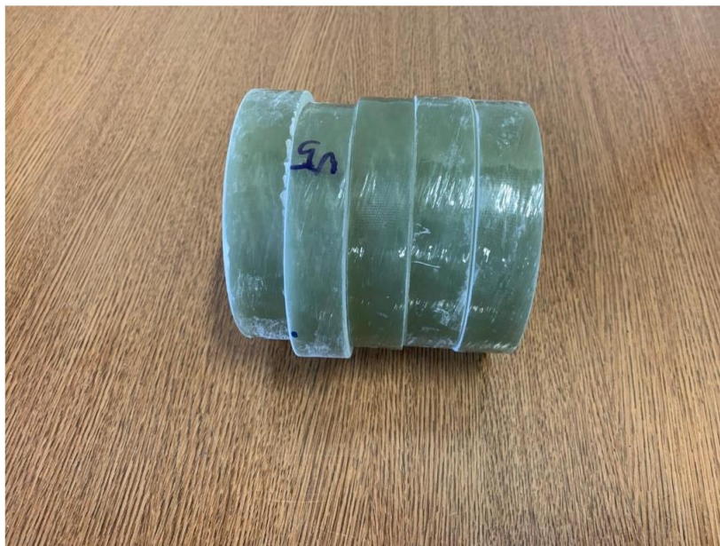
Slika 17. Uzorci s vinil esterskom matricom
