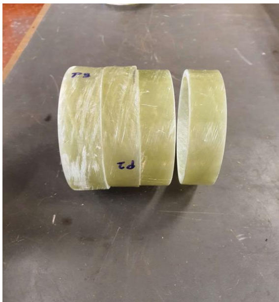
Slika 16. Uzorci s poliesterskom matricom
