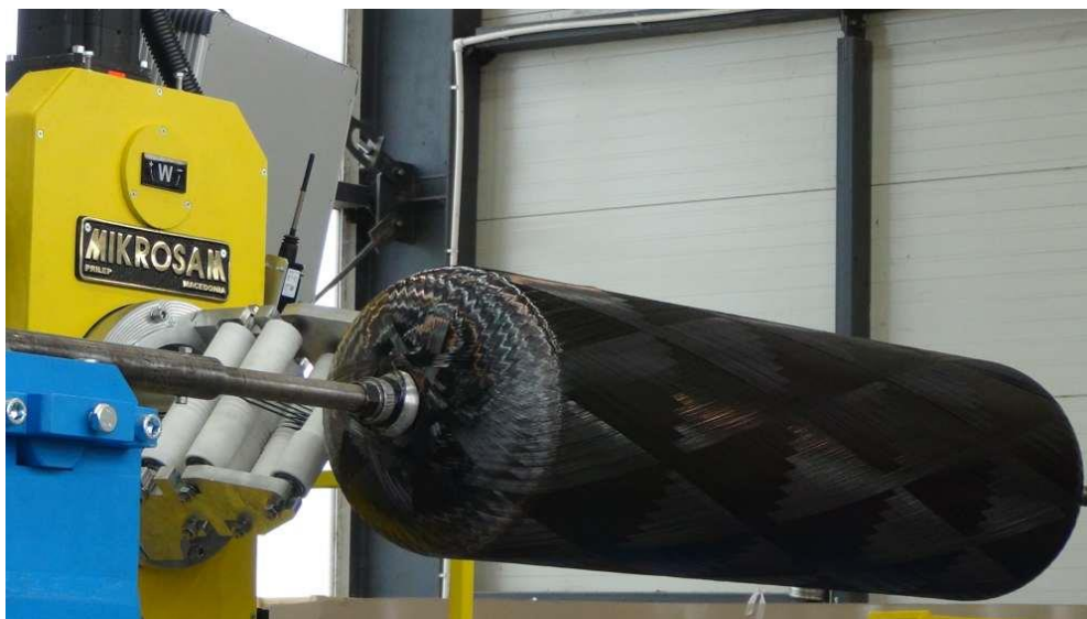
Slika 13. Namatanje ugljičnih vlakana [17]
