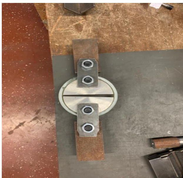
Slika 19. Alat korišten za ispitivanje vlačne čvrstoće
