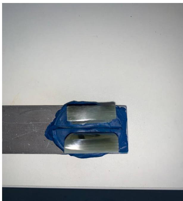
Slika 30. Uzorci nakon poliranja i brušenja
