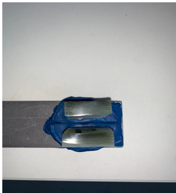
Slika 30. Uzorci nakon poliranja i brušenja
