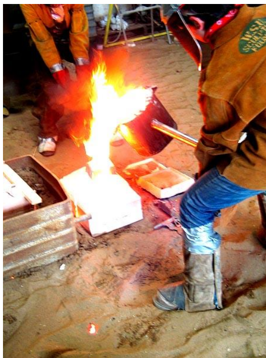
Slika 1. Lijevanje metala u kalup [5]
