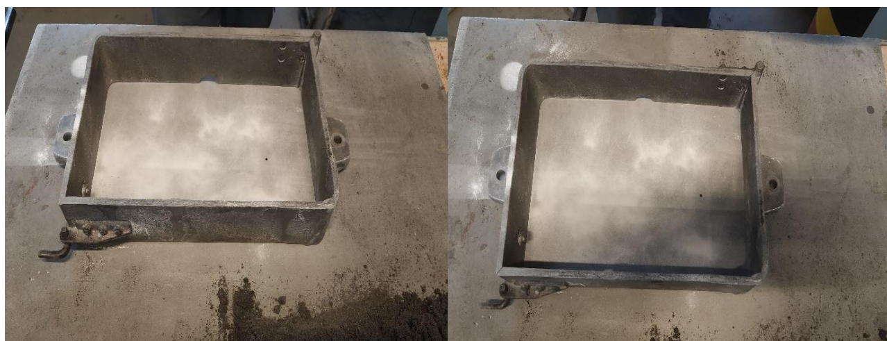
Slika 34. Postavljanje donjaka i nanošenje sredstva za razdvajanje
