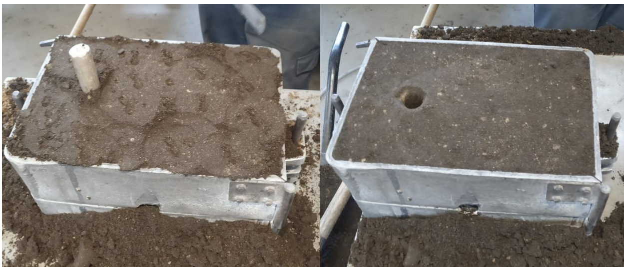
Slika 39. Sabijanje kalupne mješavine i vađenje modela pojila
