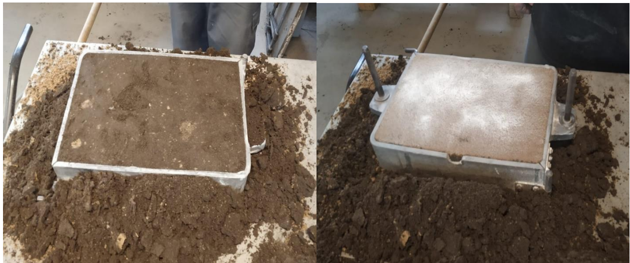
Slika 36. Sabijanje kalupne mješavine i dodavanje sredstva za razdvajenje
