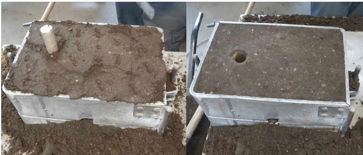
Slika 39. Sabijanje kalupne mješavine i vađenje modela pojila
