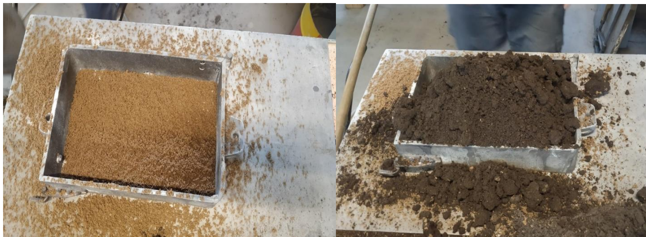
Slika 35. Dodavanje modelne i punidbene kalupne mješavine
