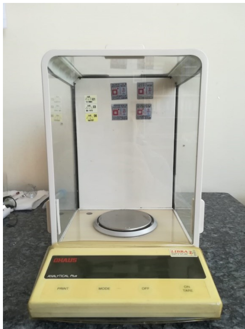
Slika 4.8 Precizna vaga Ohaus Analytical Plus
