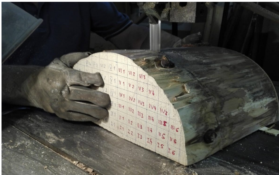
Slika 4.2 Izrezivane uzoraka na strojnoj pili
