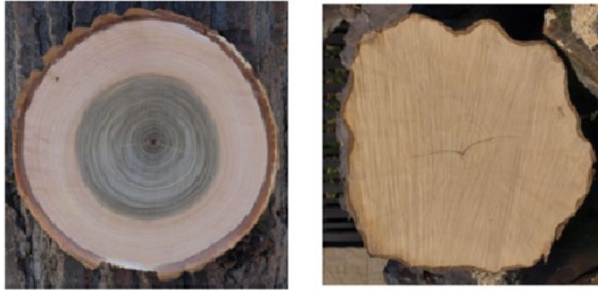
Slika 2.7 Poprečni presjek kroz jedričavu (lijevo) i bakuljavu vrstu drva (desno) [1]
