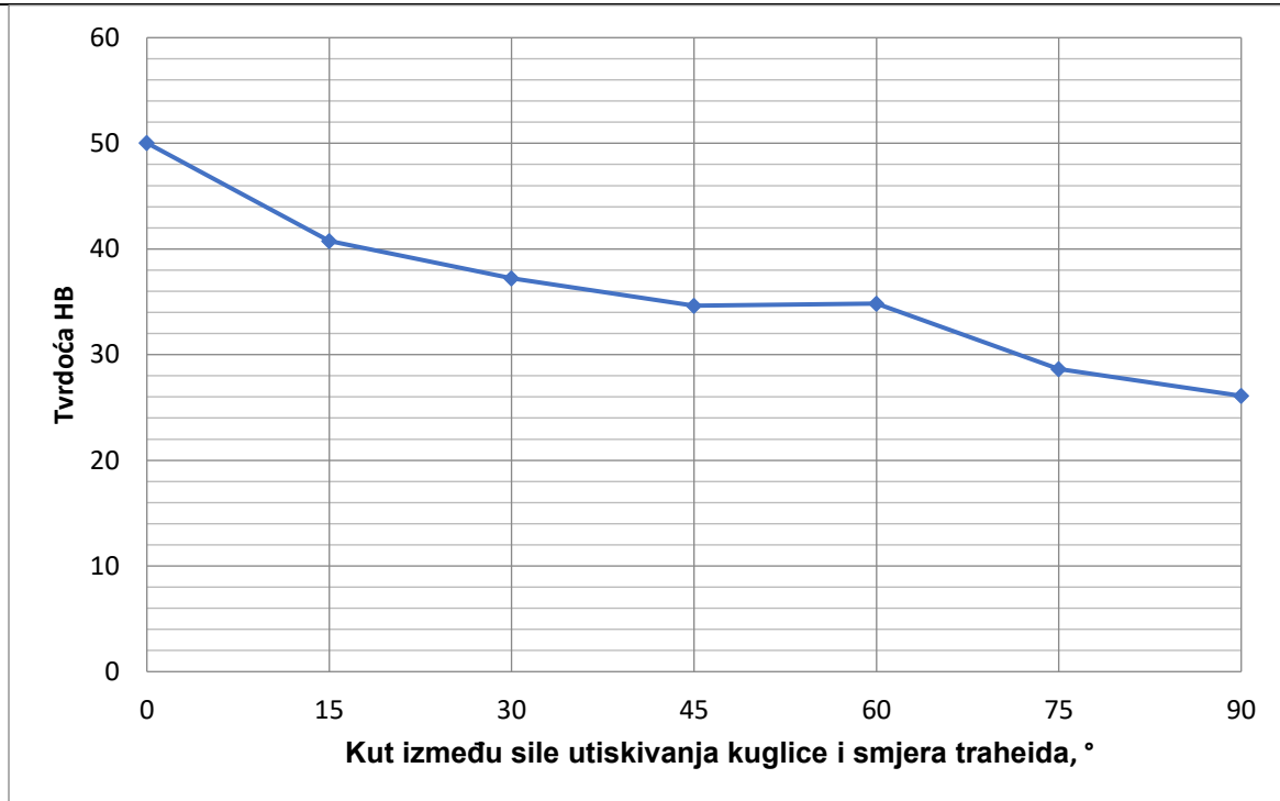
Slika 5.8 Utjecaj usmjerenosti strukture na tvrdoću HB
