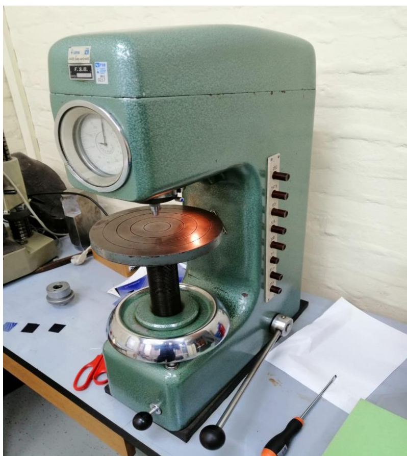
Slika 4.6 Tvrdomjer VEB WPM HP 250
