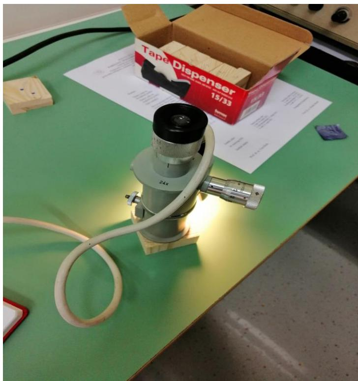
**Slika 4.8 Uredaj za precizno mjerjenje promjera otiska**
