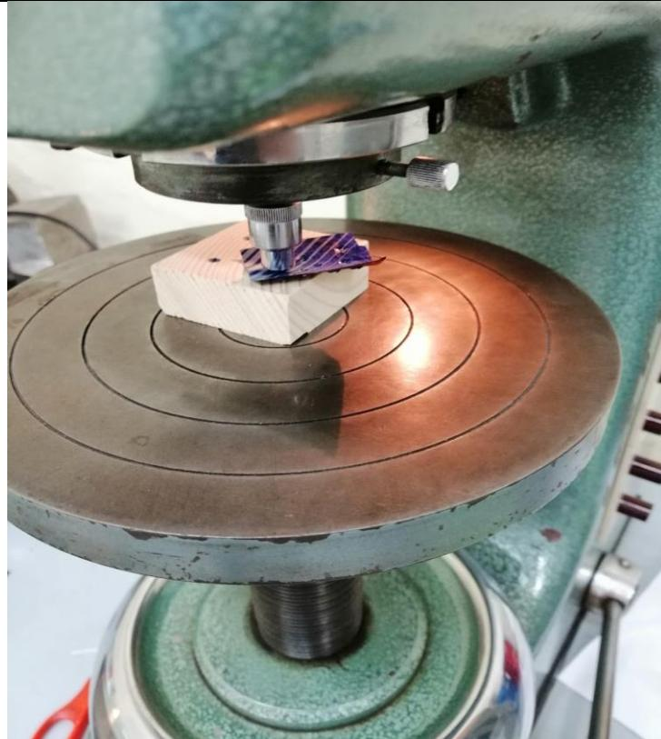
**Slika 4.7 Mjerenje tvrdoće**
