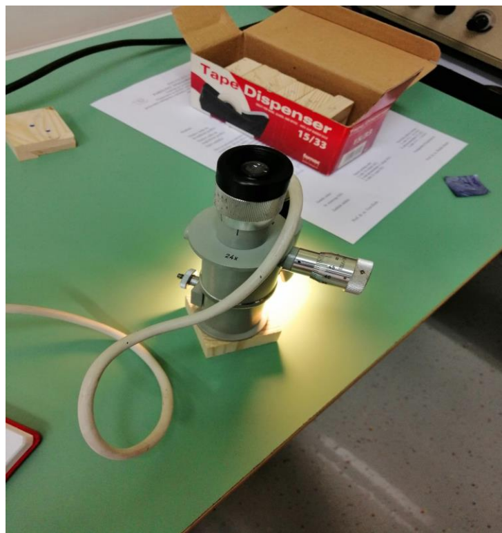
Slika 4.8 Uredaj za precizno mjerenje promjera otiska
