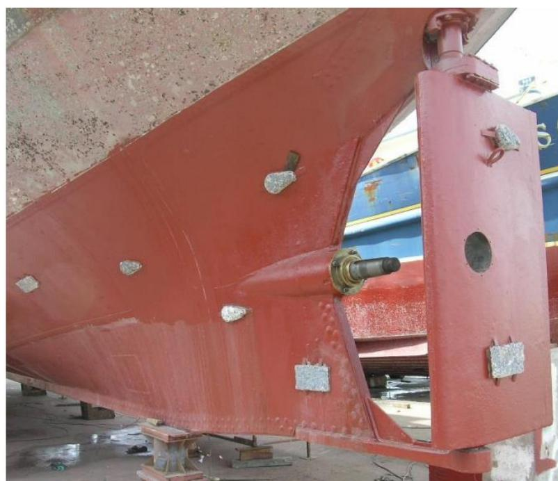
**Slika 35.** Protektorska zaštita podvodnog dijela čeličnog trupa broda žrtvujućim anodama od cinka. [29]
