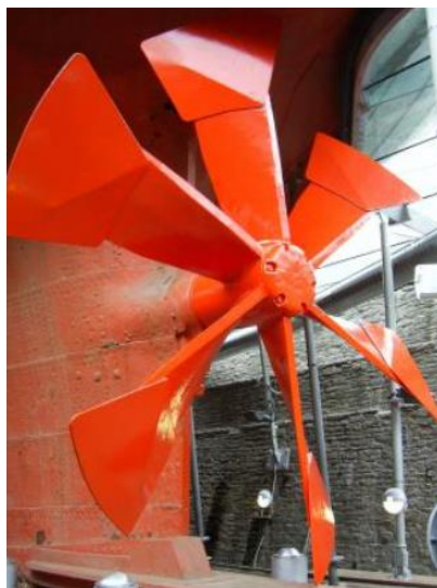
Slika 5. Brodski vijak po uzoru na SS Great Britain [4]
