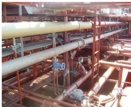
**Slika 33. Cijevni sustav od nehrđajućeg čelika na palubi broda [30]**
