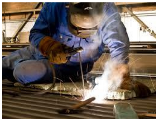
Slika 3-2 Elektrolučno zavarivanje elektrodom [6]
