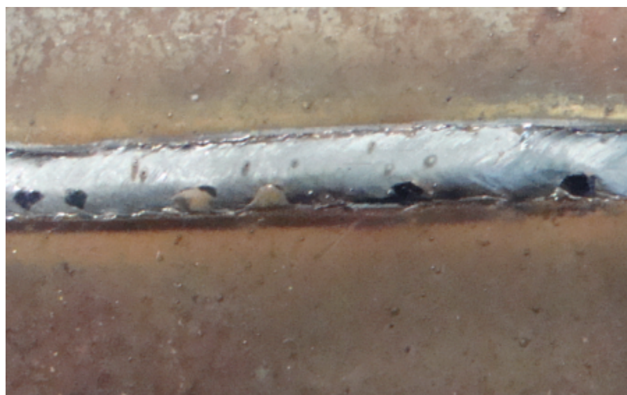
Slika 86. Izgled zavara s uspješnim pra enjem pomo u senzora elektri nog luka
