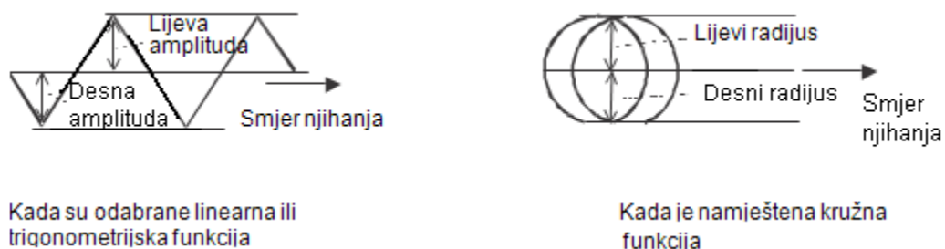
Slika 59. Izgled amplitude njihanja
