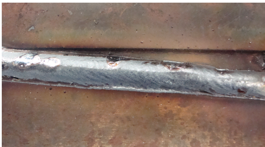
Slika 85. Izgled zavara s neuspjelim pra enjem pomo u senzora elektri nog luka
