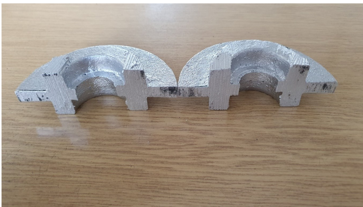
Slika 56. Poprečni presjek odljevka od legure AlSi7Mg
