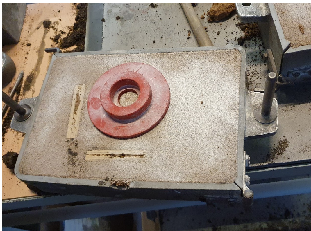
Slika 37. Donjak nakon otvaranja kalupa
