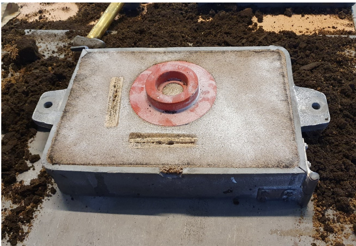
Slika 30. Pozicija razvodnika i modela u donjaku
