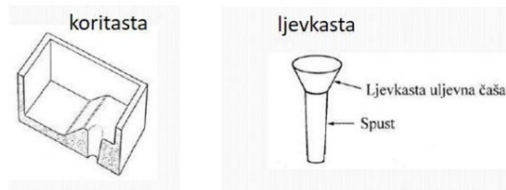
Slika 4. Vrste uljernih čaša [1]
