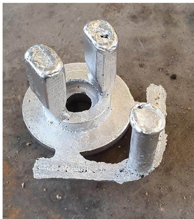
**Slika 45. Odljevak s uljevnim sustavom**
