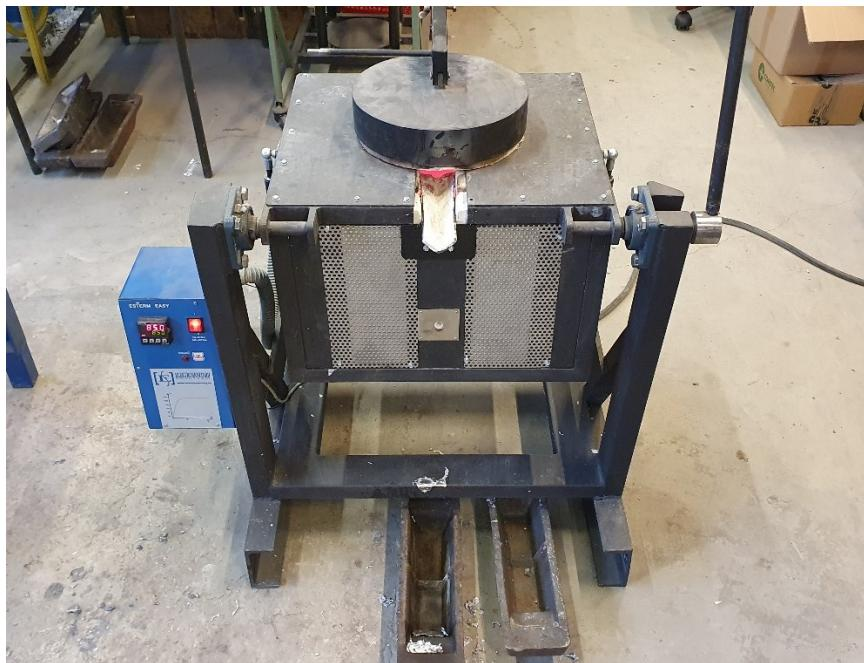
Slika 40. Elektrootporna peć
