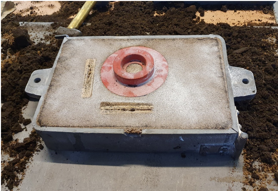
Slika 30. Pozicija razvodnika i modela u donjaku
