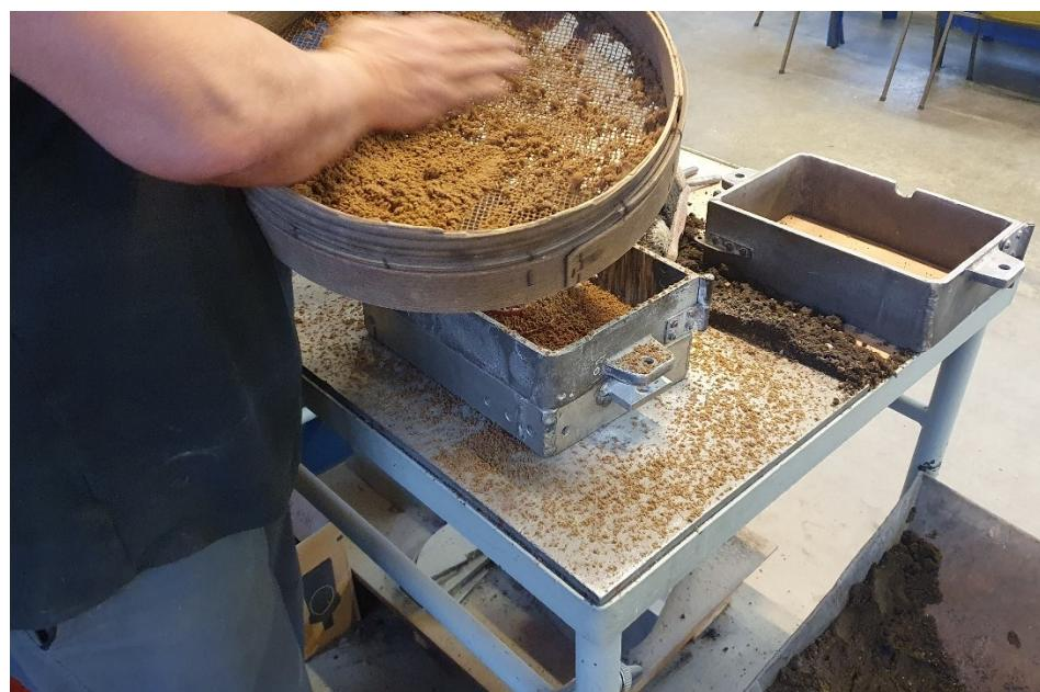
Slika 27. Nasipavanje modelnom kalupnom mješavinom
