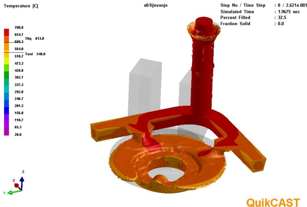
Slika 46. Simulacija ulijevanja taline AlSi7Mg
