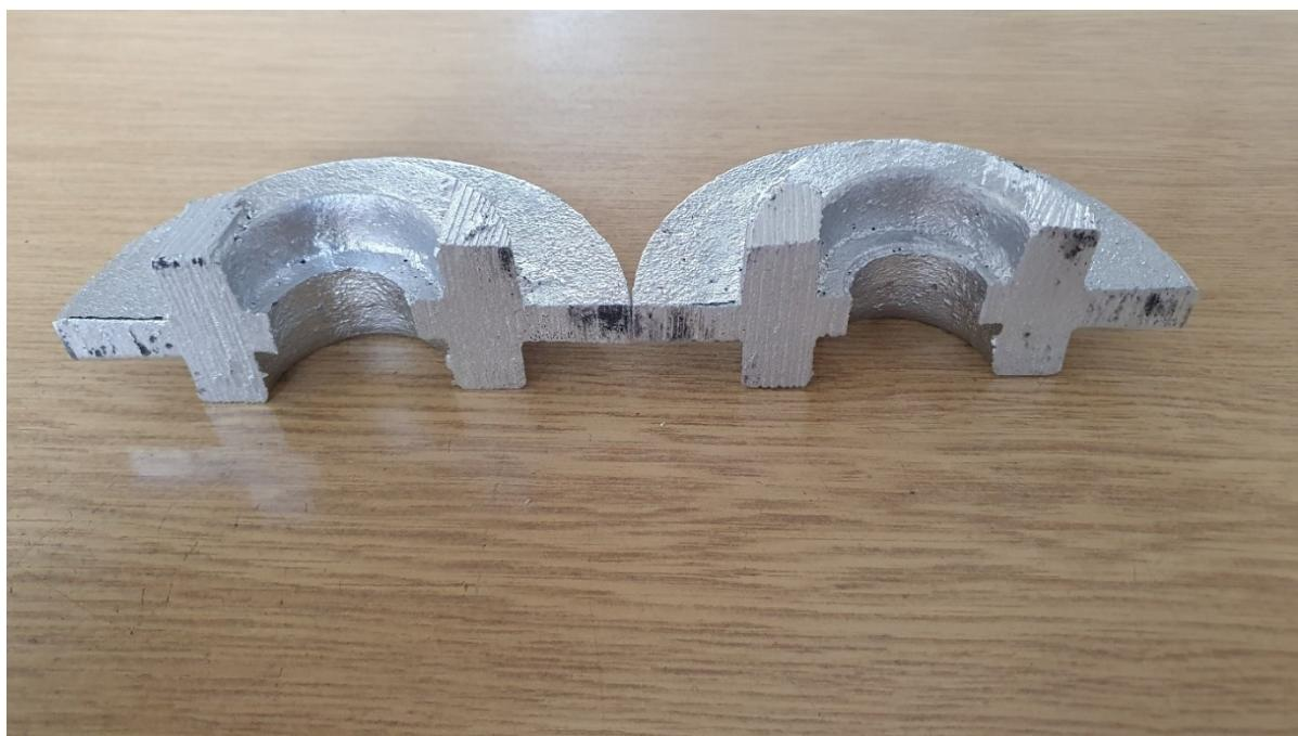
Slika 56. Poprečni presjek odljevka od legure AlSi7Mg
