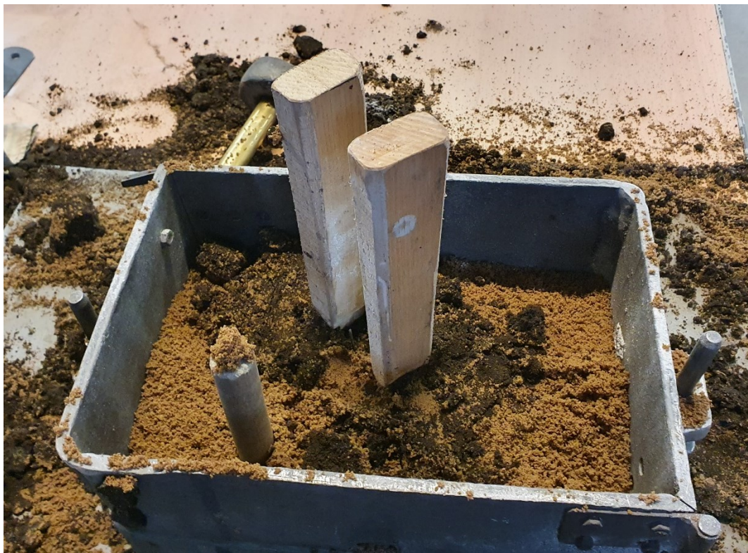
Slika 32. Postavljanje pojila i dodavanje punidbene kalupne mješavine
