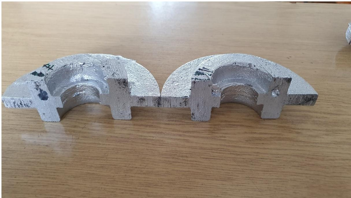
**Slika 57. Poprečni presjek odljevka od legure AlSi13**
