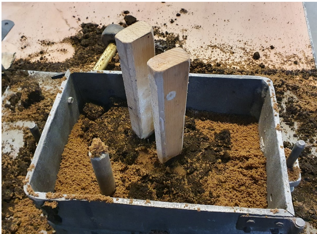
Slika 32. Postavljanje pojila i dodavanje punidbene kalupne mješavine
