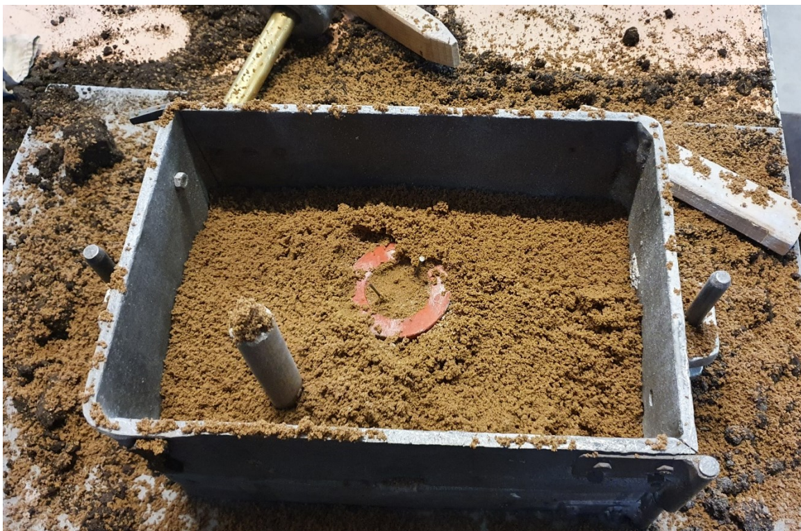
Slika 31. Postavljanje spusta i nasipavanje modelne kalupne mješavine u gornjak
