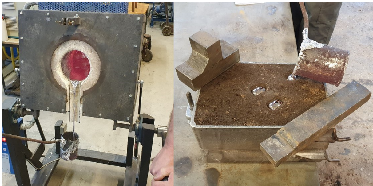
Slika 43. Izlijevanje iz peći i ulijevanje u kalup
