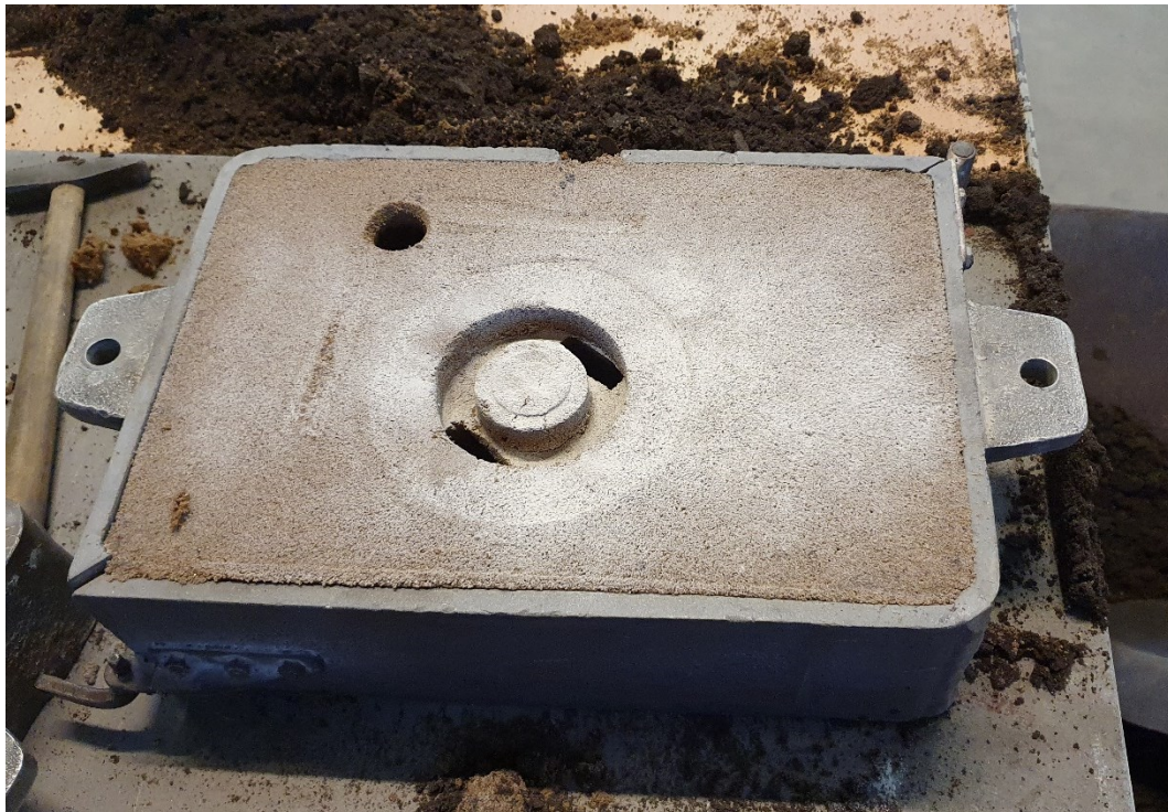
Slika 36. Gornjak nakon otvaranja kalupa
