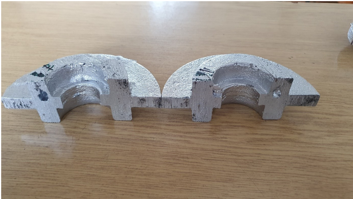
Slika 57. Poprečni presjek odljevka od legure AlSi13
