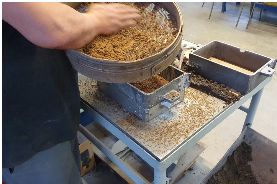
Slika 27. Nasipavanje modelnom kalupnom mješavinom
