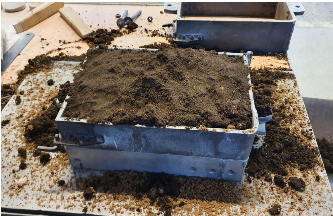
Slika 28. Dodana punidbena kalupna mješavina
