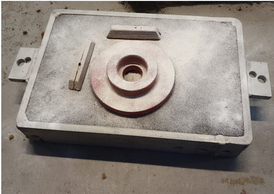
Slika 26. Model i razvodnici u položaju za izradu donjaka
