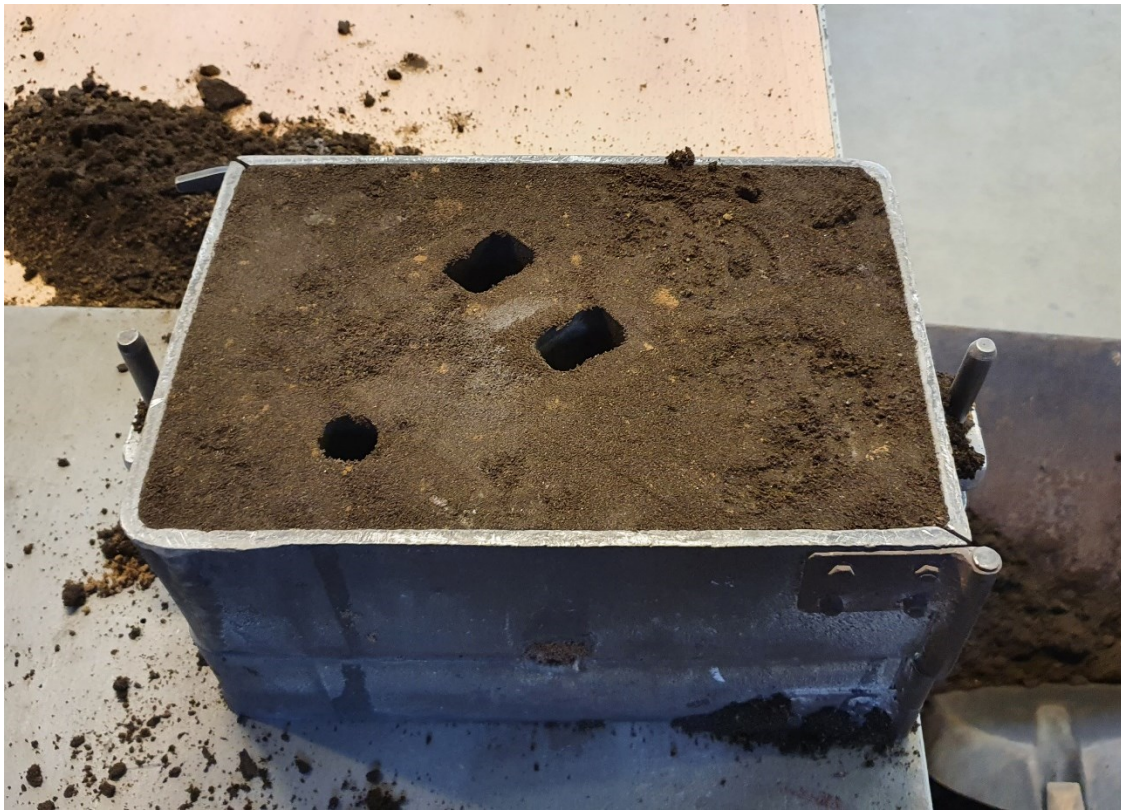
Slika 34. Gornjak nakon vađenja spusta i pojila
