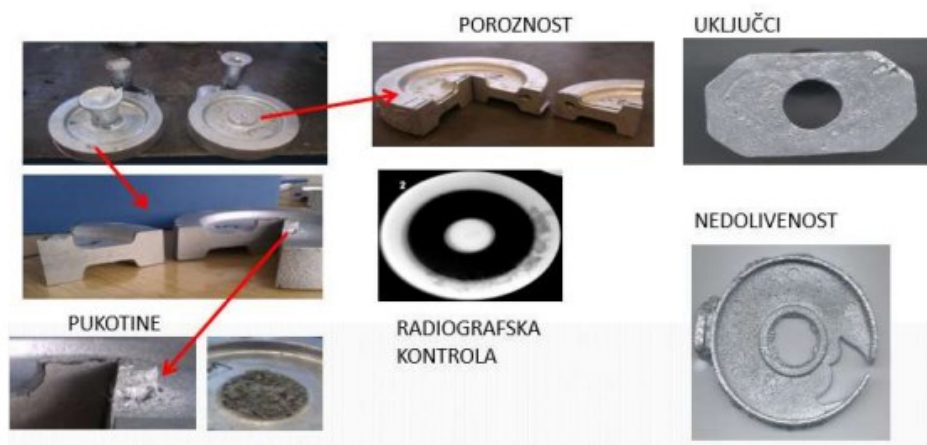
Slika 2. Osnovne greške na odljercima [1]
