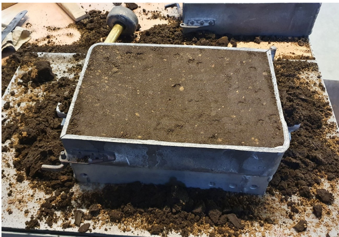
Slika 29. Donjak nakon sabijanja i poravnavanja kalupne mješavine
