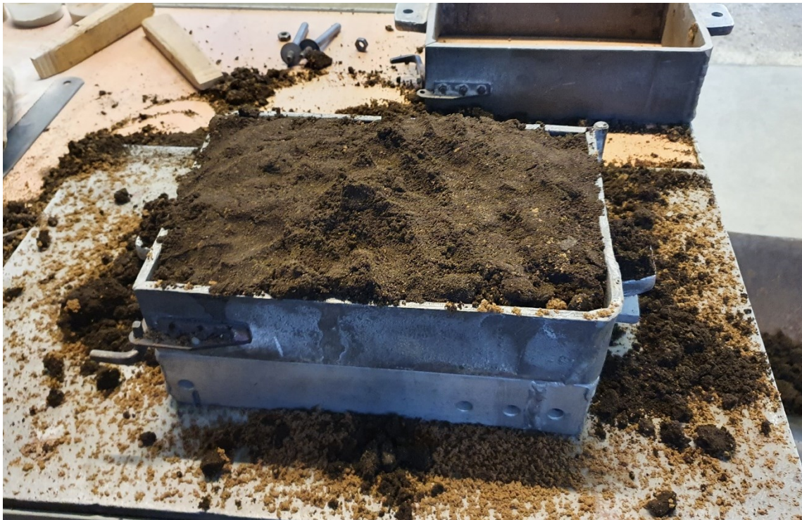
Slika 28. Dodana punidbena kalupna mješavina
