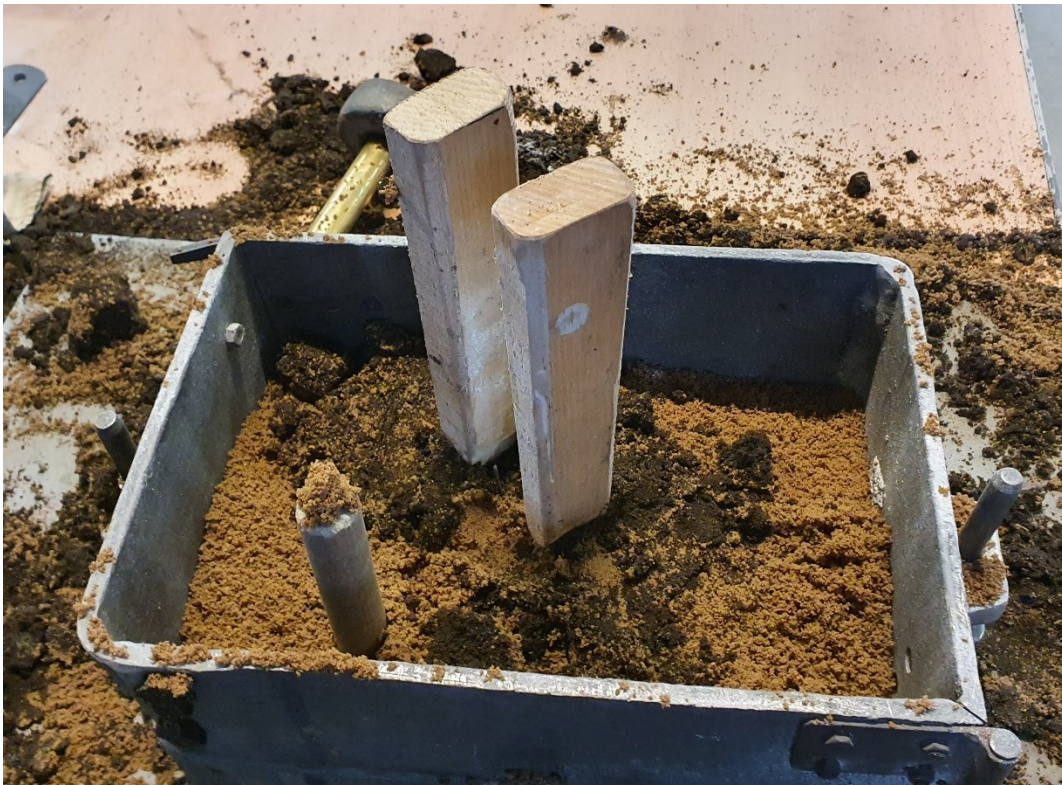
Slika 32. Postavljanje pojila i dodavanje punidbene kalupne mješavine
