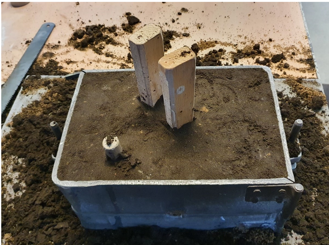
Slika 33. Gornjak nakon sabijanja i poravnavanja sa spustom i pojilima
