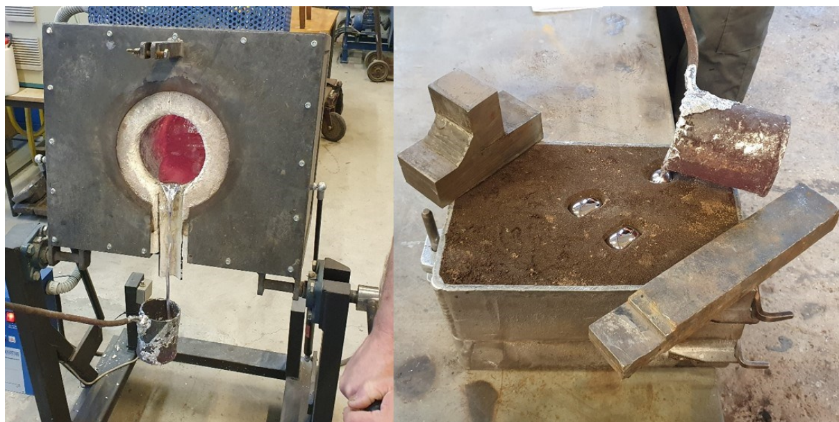
Slika 43. Izlijevanje iz peći i ulijevanje u kalup
