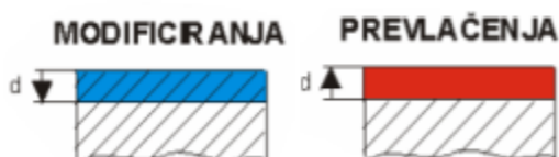
Slika 1. Razlika između modificiranja i prevlačenja [1]
