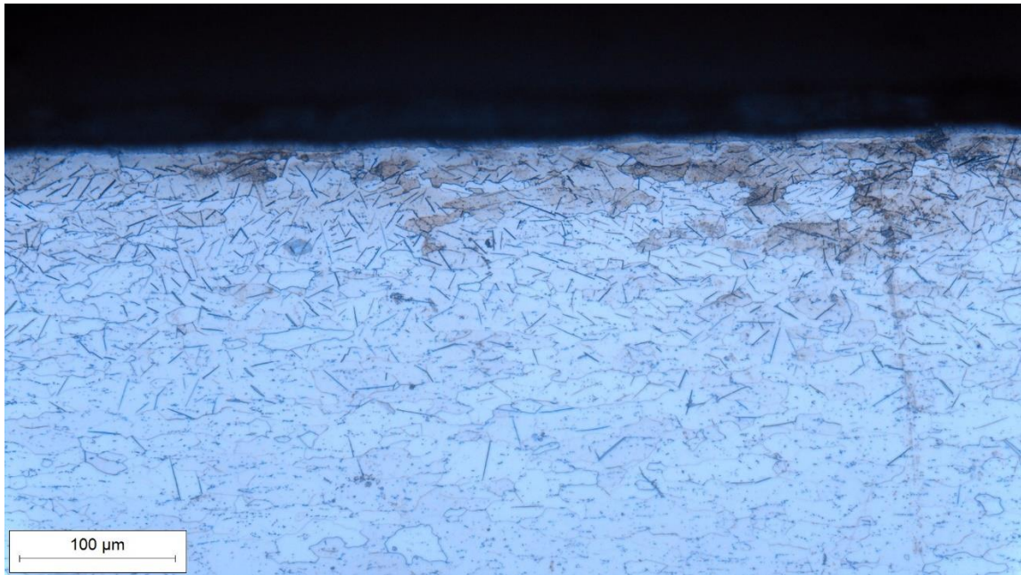
Slika 23. Prikaz QPQ obrade, povećanje 200x
