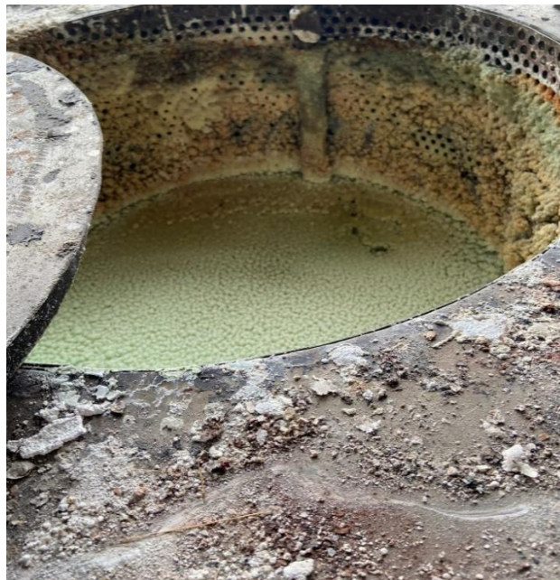
Slika 14. „DURFERRIT TF1“ sol
