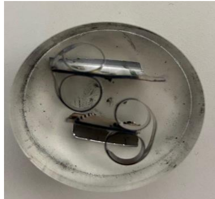
Slika 19. Uzorak uliven u polimernu masu
