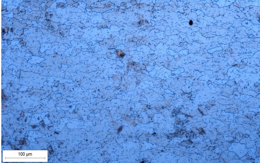
Slika 20. Prikaz osnovnog materijala pri povećanju 200x
