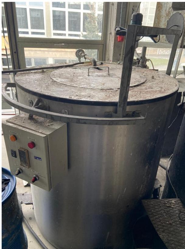
Slika 17. Jamska peć za naknadnu oksidaciju
