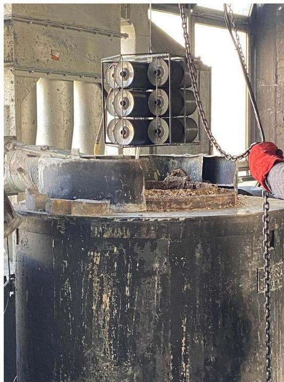
Slika 13. jamske peći „DURFERRIT-DEGUSSA GmbH“
