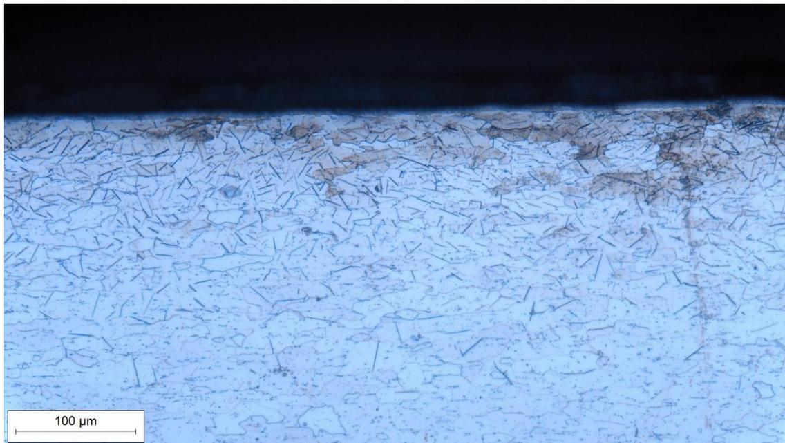
Slika 23. Prikaz QPQ obrade, povećanje 200x
