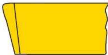
Slika 2.8. Deformacija rezne oštrice [7]
