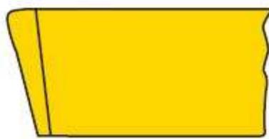
Slika 2.8. Deformacija rezne oštice [7]
