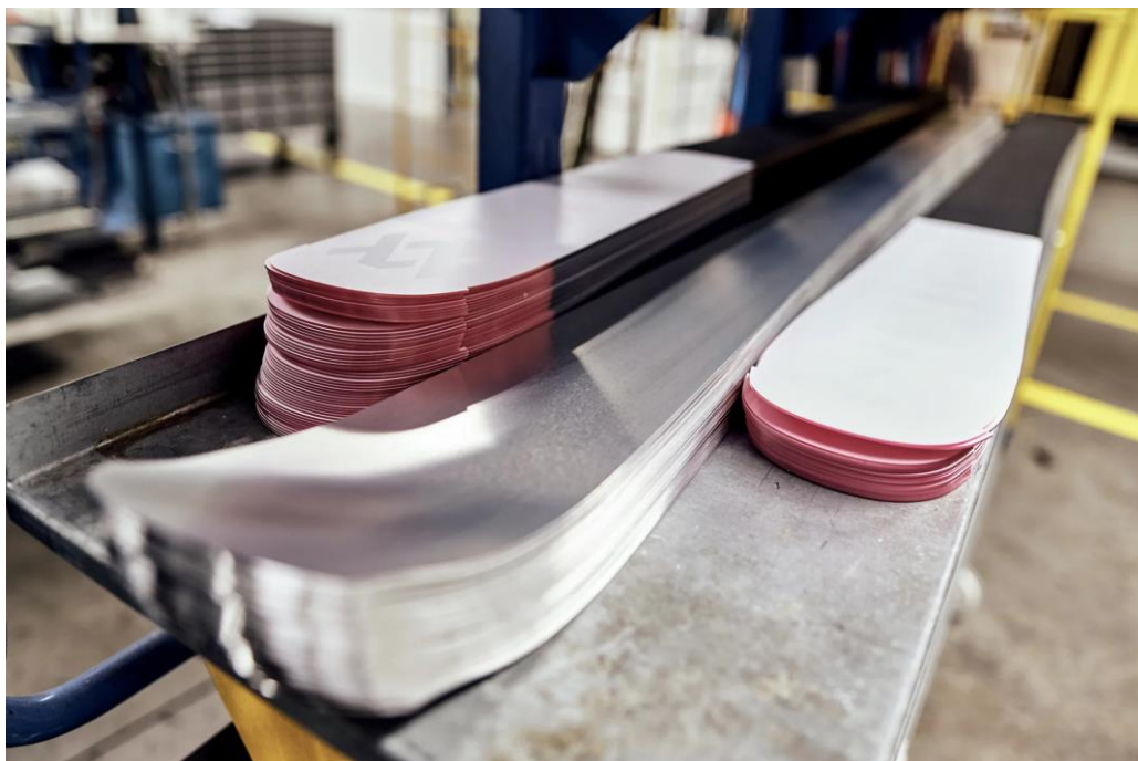
Slika 2.12. Völkl titanal ploče za skije [32]
