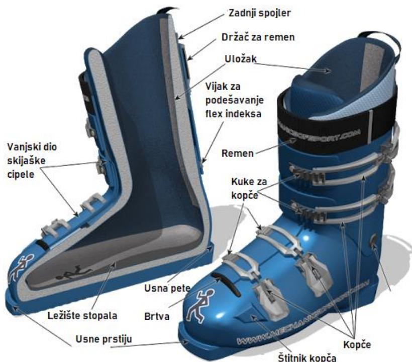
Slika 2.22. Dijelovi skijaške cipele [37]
