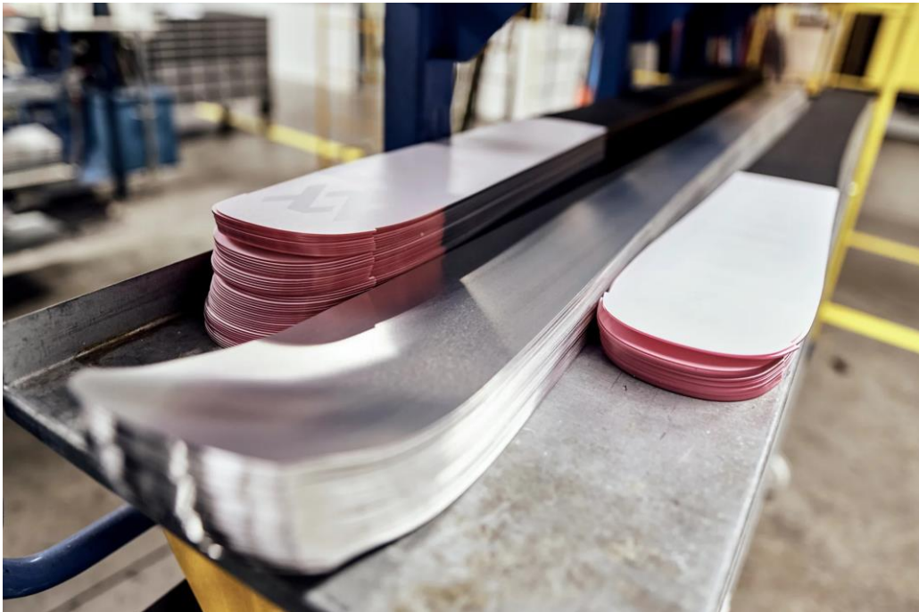
Slika 2.12. Völkl titanal ploče za skije [32]
